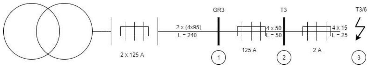
**Slika 5.4.** Jednopolna shema od TS 2x630 kVA do podrazdjelnice T3/6. [3]
