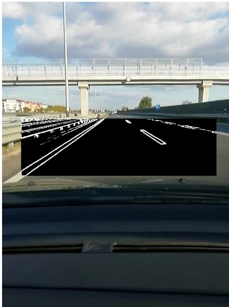
Slika 3.15. Prikaz vozne trake nakon *ColorFilter link* – a.
