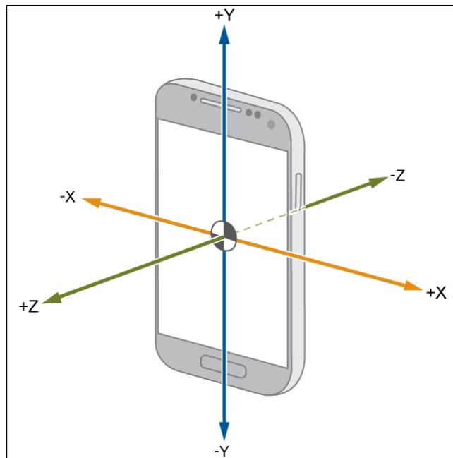
**Slika 3.2.** – Prikaz akcelerometra na Android uređaju [13]
