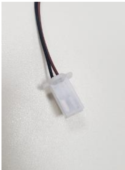
Slika 3.16 Kontakti za vožnju unatrag kontrolera HS4842580
