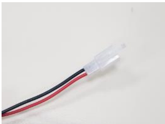
Slika 3.17 Kontakti za dodatno napajanje kontrolera HS4842580
