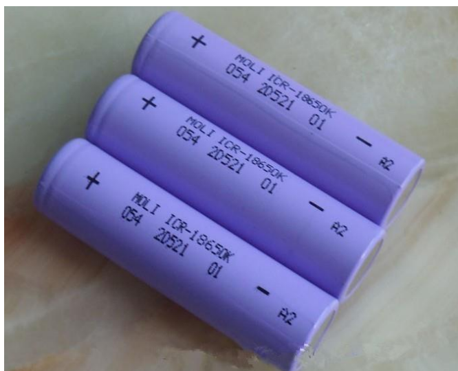
Slika 2.26 Tri Molicel ICR-18650K baterijska članka[29]
