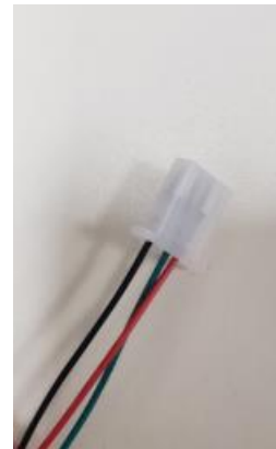
Slika 3.8 Kontakti za spajanje ručke gasa kontrolera HS4842580
