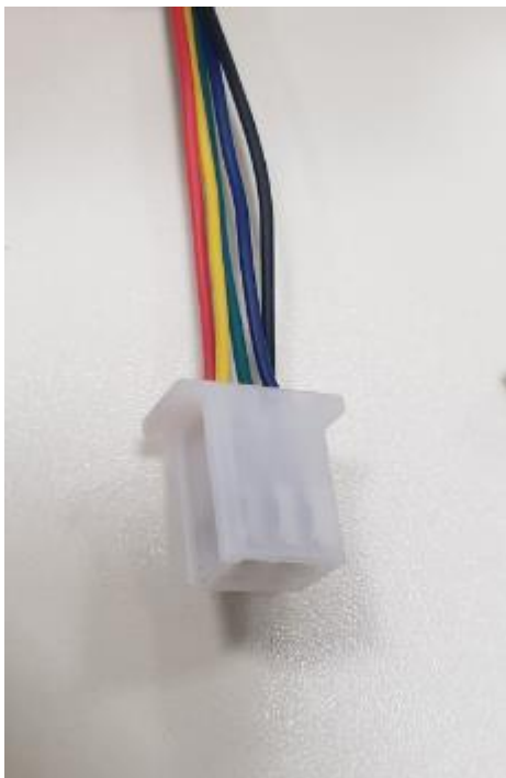
Slika 3.2 Kontektor za spajanje Hallove sonde kontrolera HS4842580
