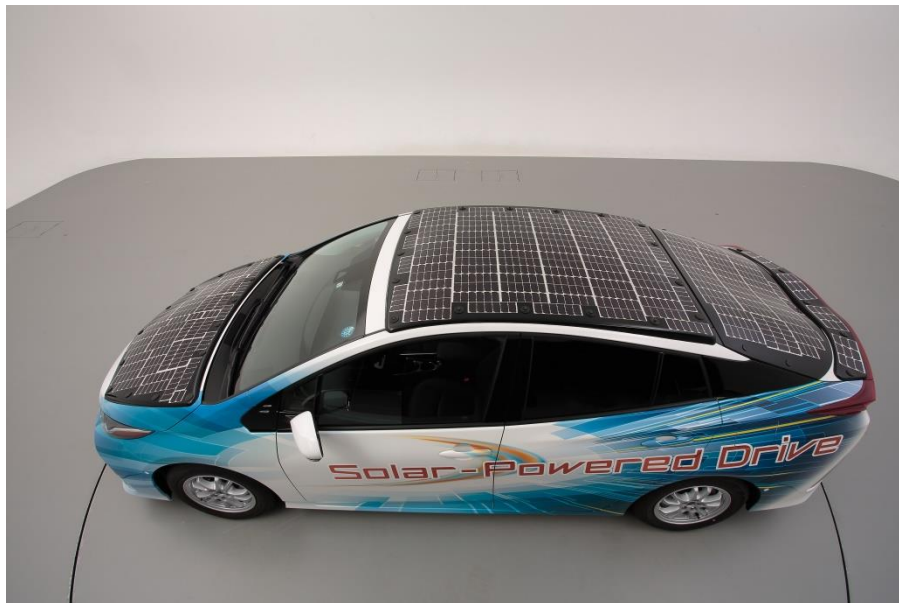
Slika 1.1 Toyota Prius solarni automobil [1]
