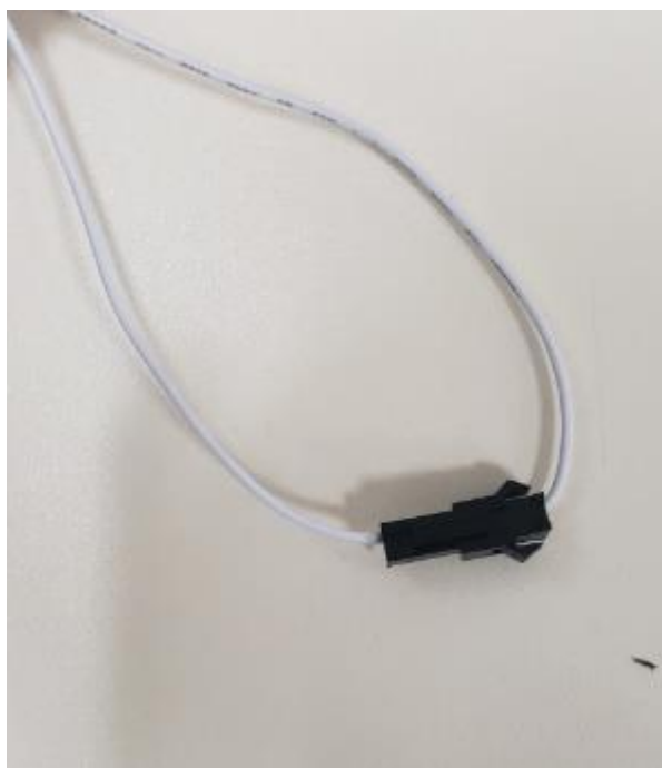
Slika 3.18 Kratko spojeni kontakti za samoučenje kontrolera HS4842580
