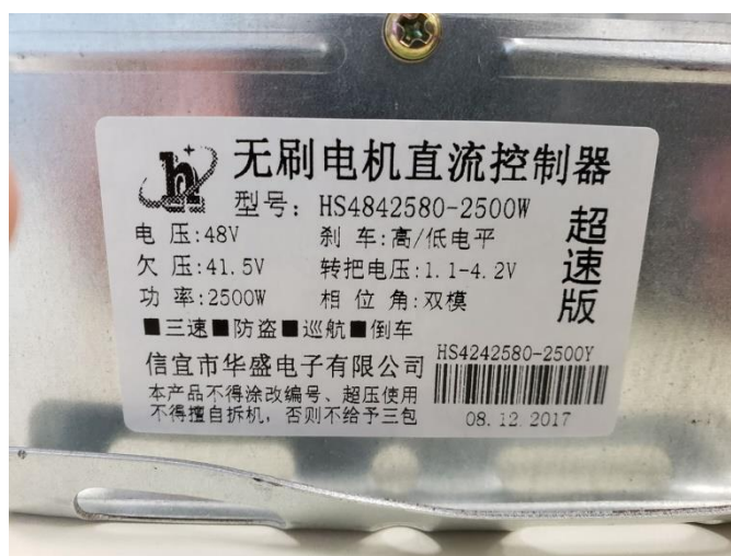
Slika 3.1 Specifikacija kontrolera za istosmjerni elektromotor
