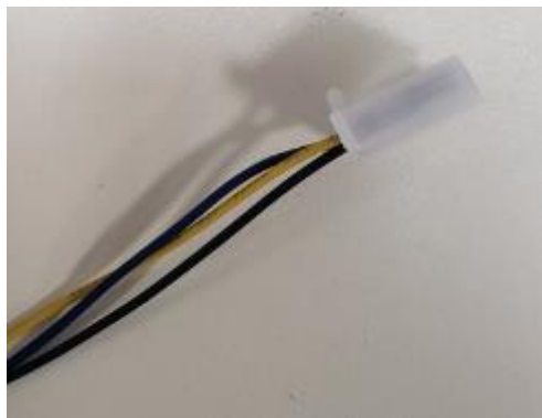
Slika 3.14 Kontakti za spajanje trobrzinske sklopke kontrolera HS4842580
