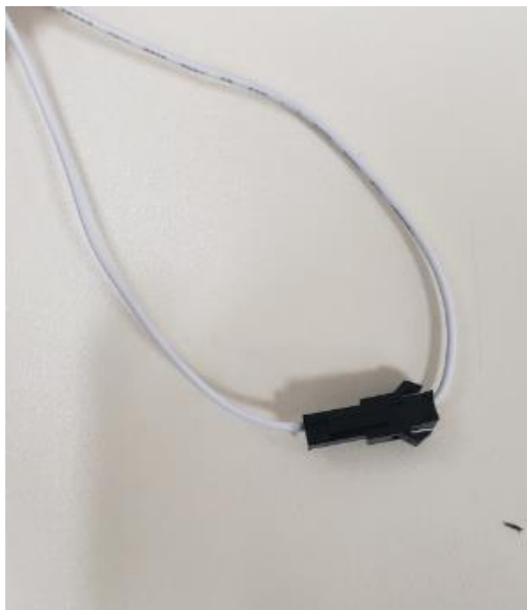
Slika 3.18 Kratko spojeni kontakti za samoučenje kontrolera HS4842580
