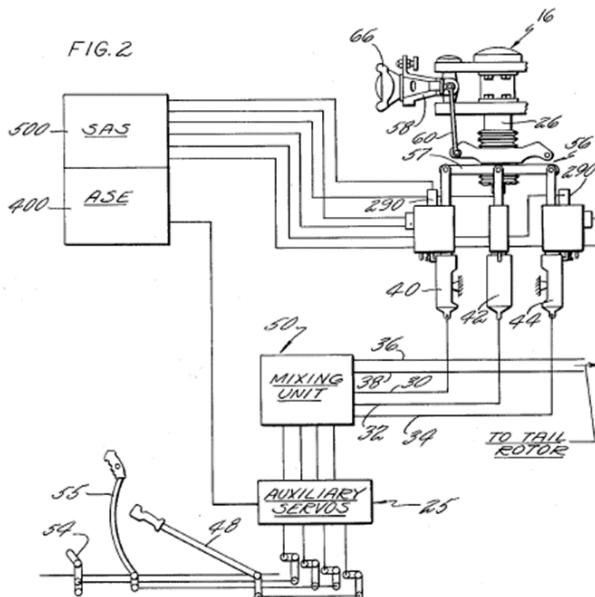
Slika 4.5. Shema mehanizma sa servo dvostrukim ulazom [22]
