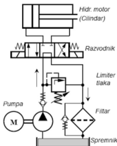
Slika 4.6. Hidraulički pogon [27]
