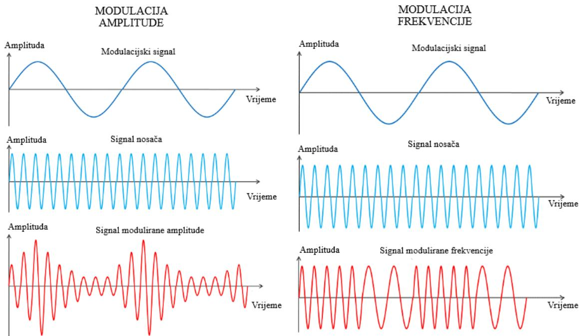
**Slika 4.2.** Modulacija amplitude i frekvencije signala [20]
