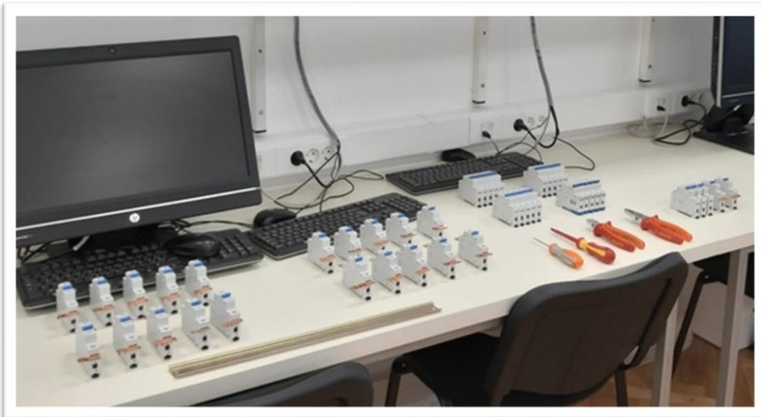
Slika 3.9. Fotografija korištenih automatskih prekidača upotrijebljenih u postupku ispitivanja
