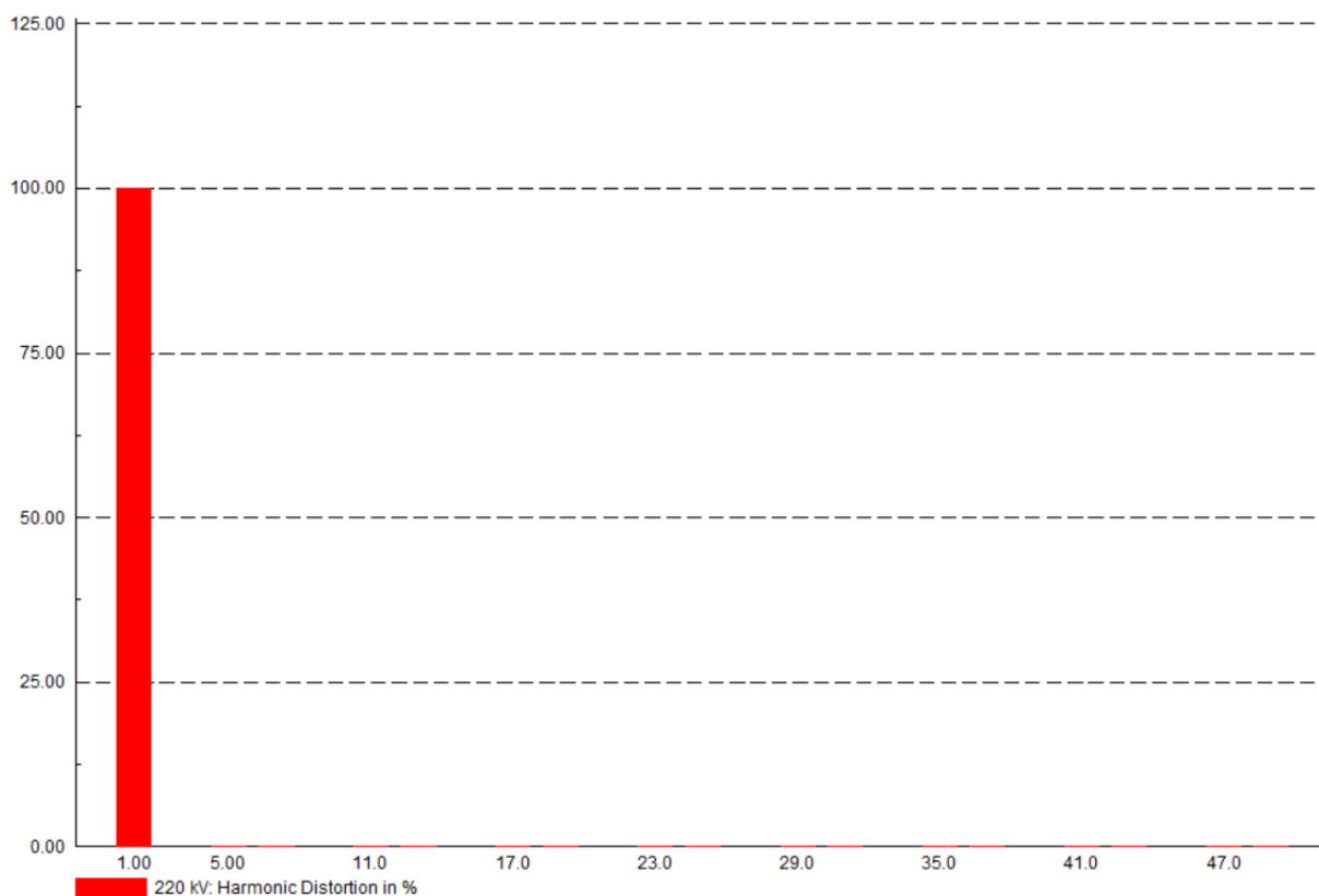
Slika 7.12. Utjecaj harmonika s isključenim teretom
