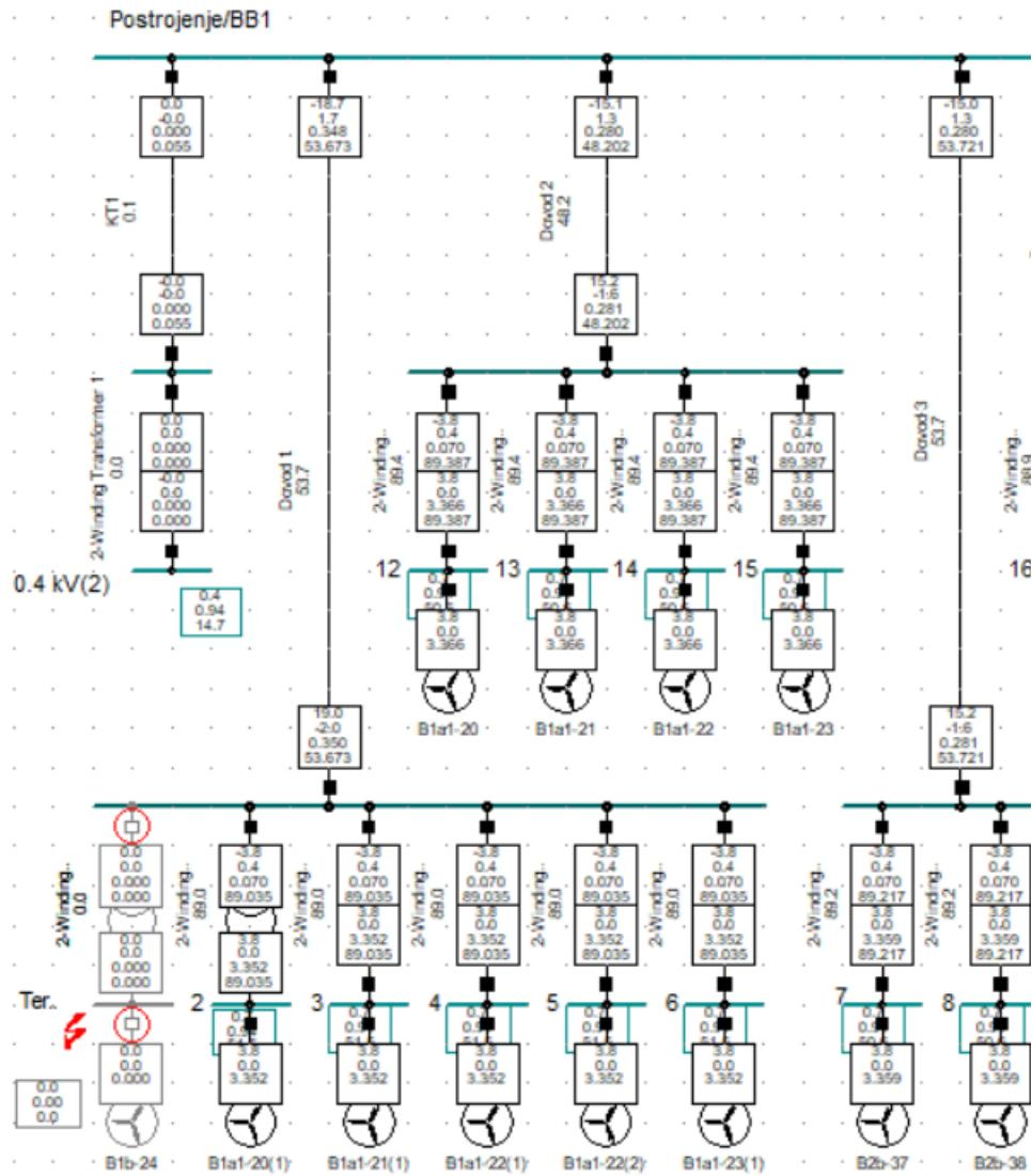
Slika 7.2. Prikaz prorade zaštite pri trofaznom kratkom spoju na sabirnici 0.7 kV Terminal(4)
