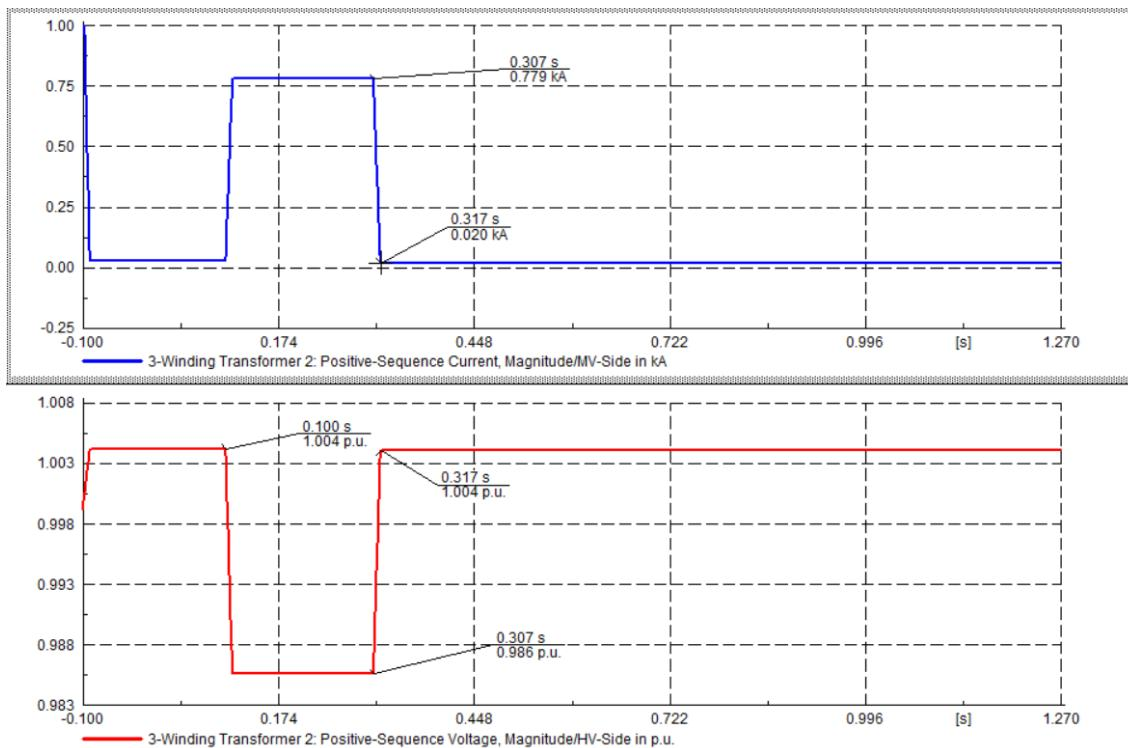
Slika 7.10. Strujno naponske krakteristike na Transformatoru 2 pri trofaznom kratkom spoju na SN strani transformatora
