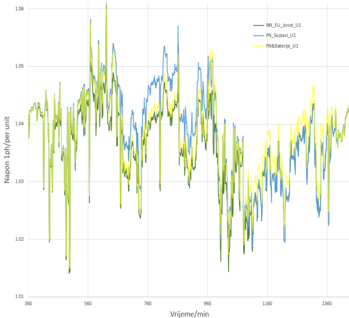
Slika 5.16. Napon prve faze na kraju izvoda za sva tri slučaja
