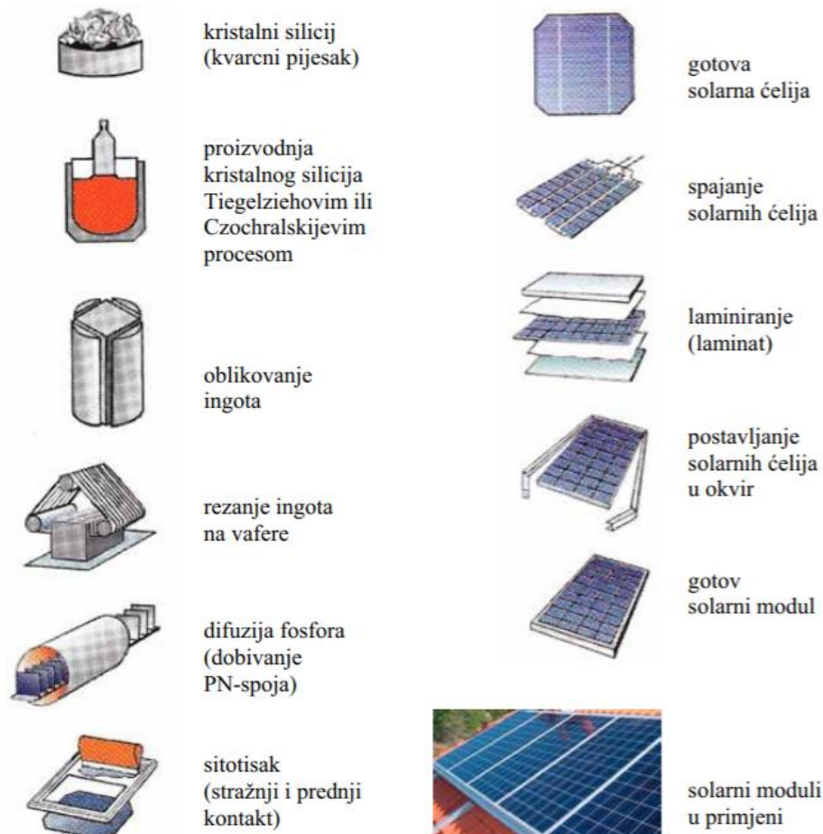
Slika 4.2.2.2. Postupak proizvodnje solarnih ćelija i solarnog modula, izvor [9]
