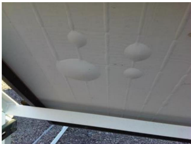
Slika 4.3.2.2. Delaminacija stražnje strane modula, izvor [18]
