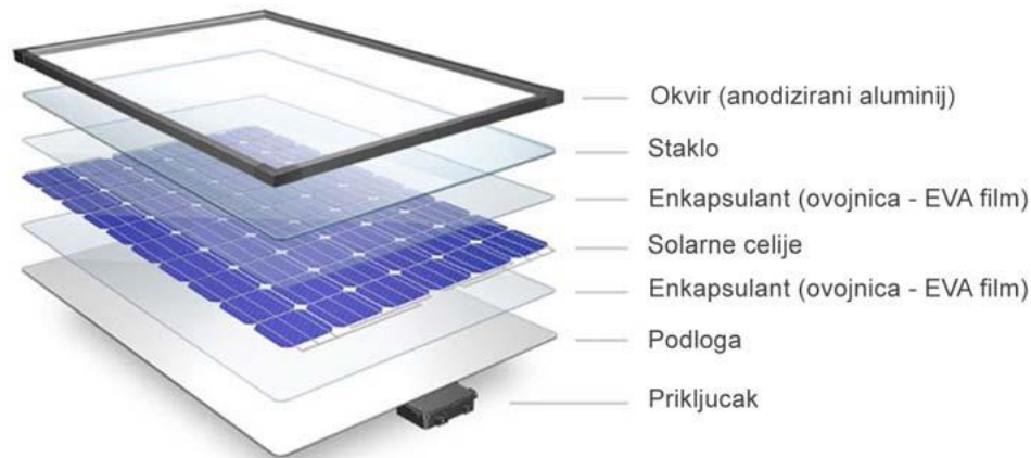
Slika 4.2.1. Struktura fotonaponske ćelije, izvor [10]
