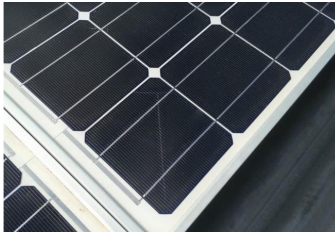
Slika 4.3.2.6 Pukotina u ćeliji, izvor [24]
