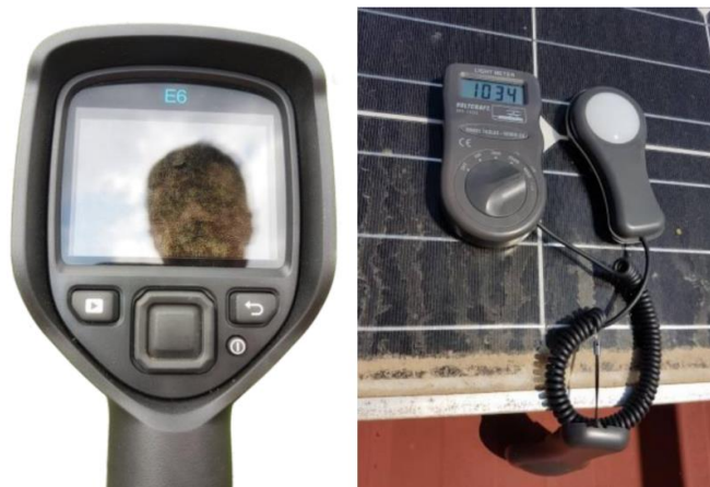
Slika 5.5. Zaslona kamere pri visokoj iluminaciji, izvor [25]
