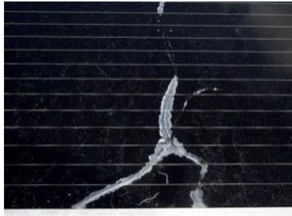
Slika 4.3.2.7. Lom stakla, izvor [17]
