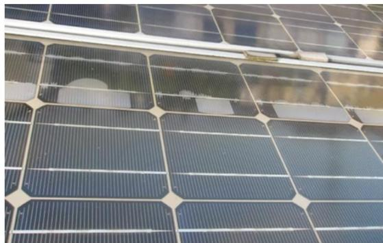
*Slika 4.3.2.1. Delaminacija c-Si modula, izvor [16]*
