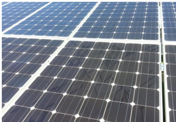
Slika 4.3.2.4. Fotografija puževe staze, izvor [21]
