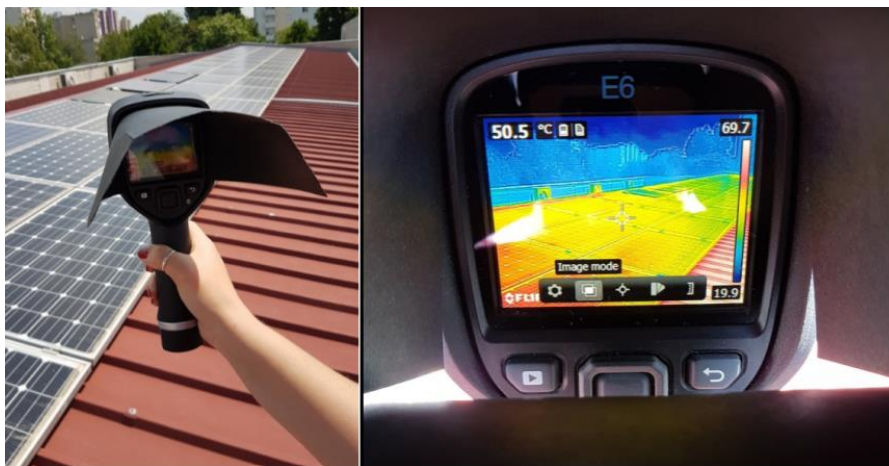
Slika 5.7. Prikaz zaslona zasjenjenog crnim papirom
