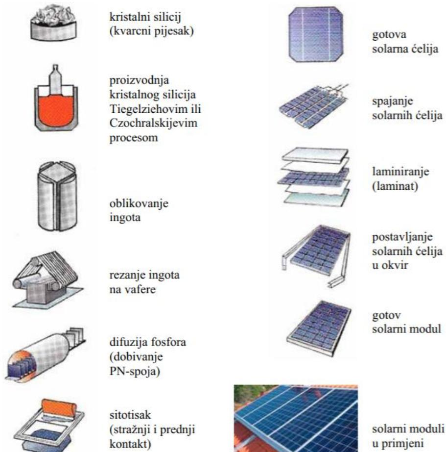
*Slika 4.2.2.2. Postupak proizvodnje solarnih čelija i solarnog modula, izvor [9]*
