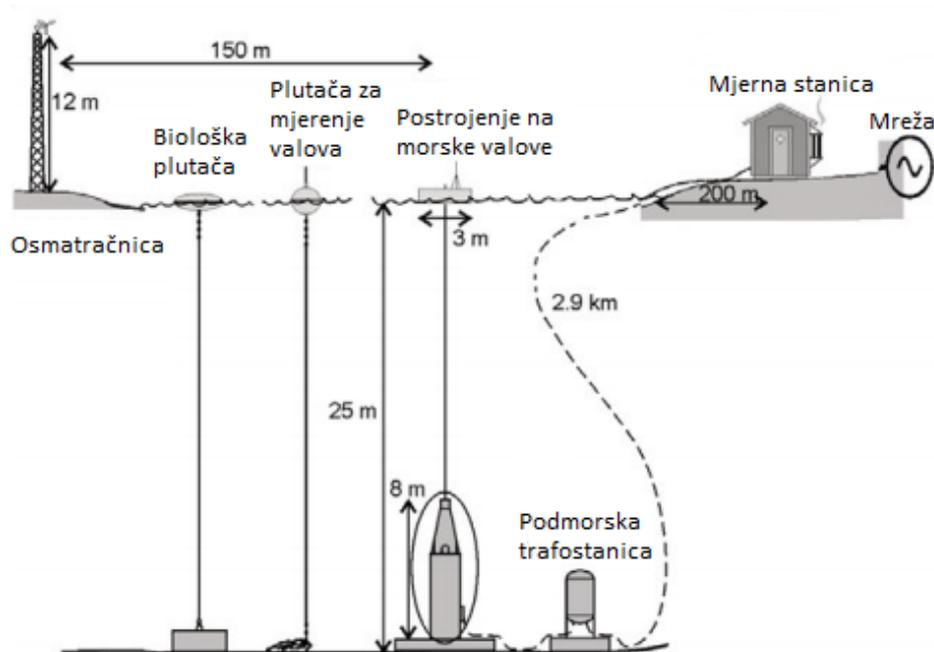
**Slika 3.3.** Pregled komponenata instaliranih na mjestu istraživanja Lysekil [1].
