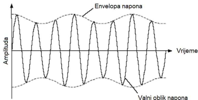
**Slika 4.7.** Valni oblik napona na promjenjivom opterećenju. [8].
