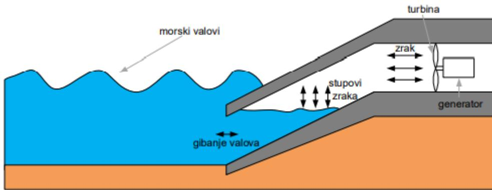
**Slika 2.6.** Postrojenje s oscilirajućim vodenim stupcem. [4]
