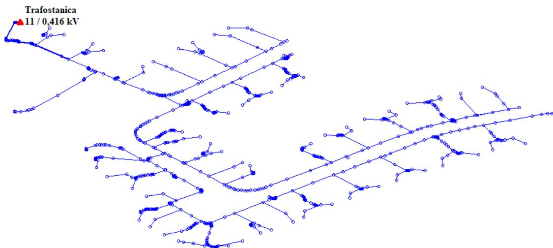
Slika 5.2. Jednopolna shema IEEE niskonaponskog testnog izvoda.
