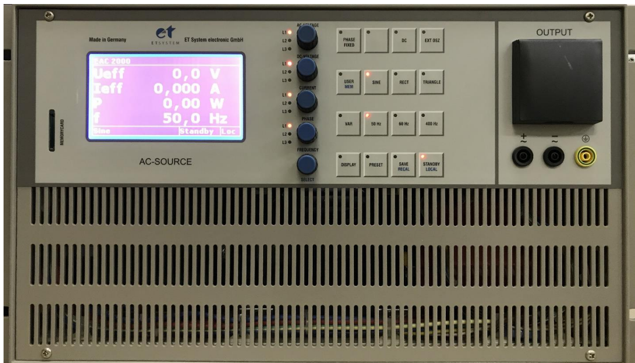
Slika 4.2. Programabilni izmjenični laboratorijski izvor ET System EAC-S2000.
