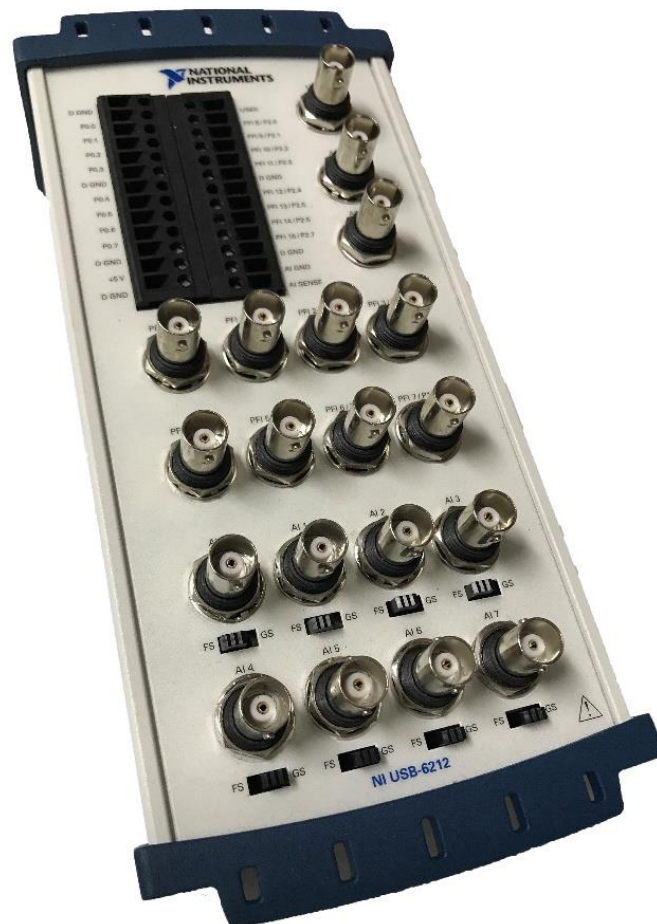
Slika 2.6. Multifunkcijska akvizicijska (DAQ) kartica National Instruments NI-USB 6212.
