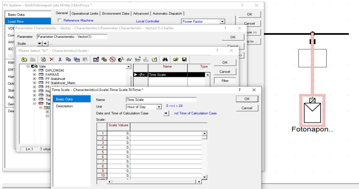
Slika 4.5. Dodavanje satne proizvodnje fotonaponskoj elektrani korak 2
