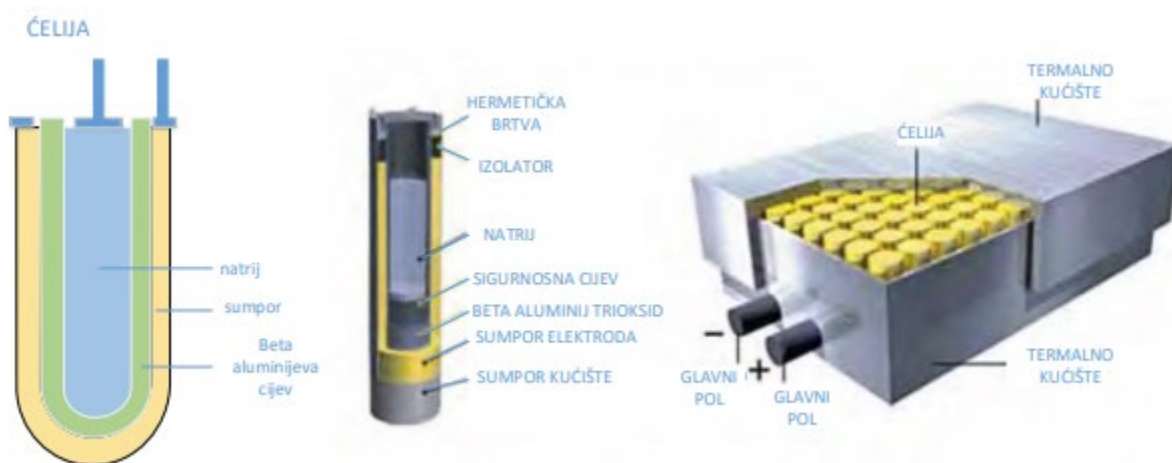
Slika 4.7: Presjek NaS baterije i modula [9]
