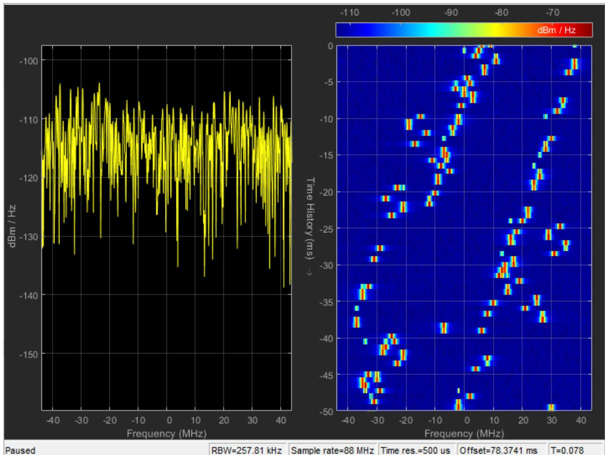
Slika 5.53. Spektar primljenog signala te spektrogram kanala SCORT/AWGN/3&4
