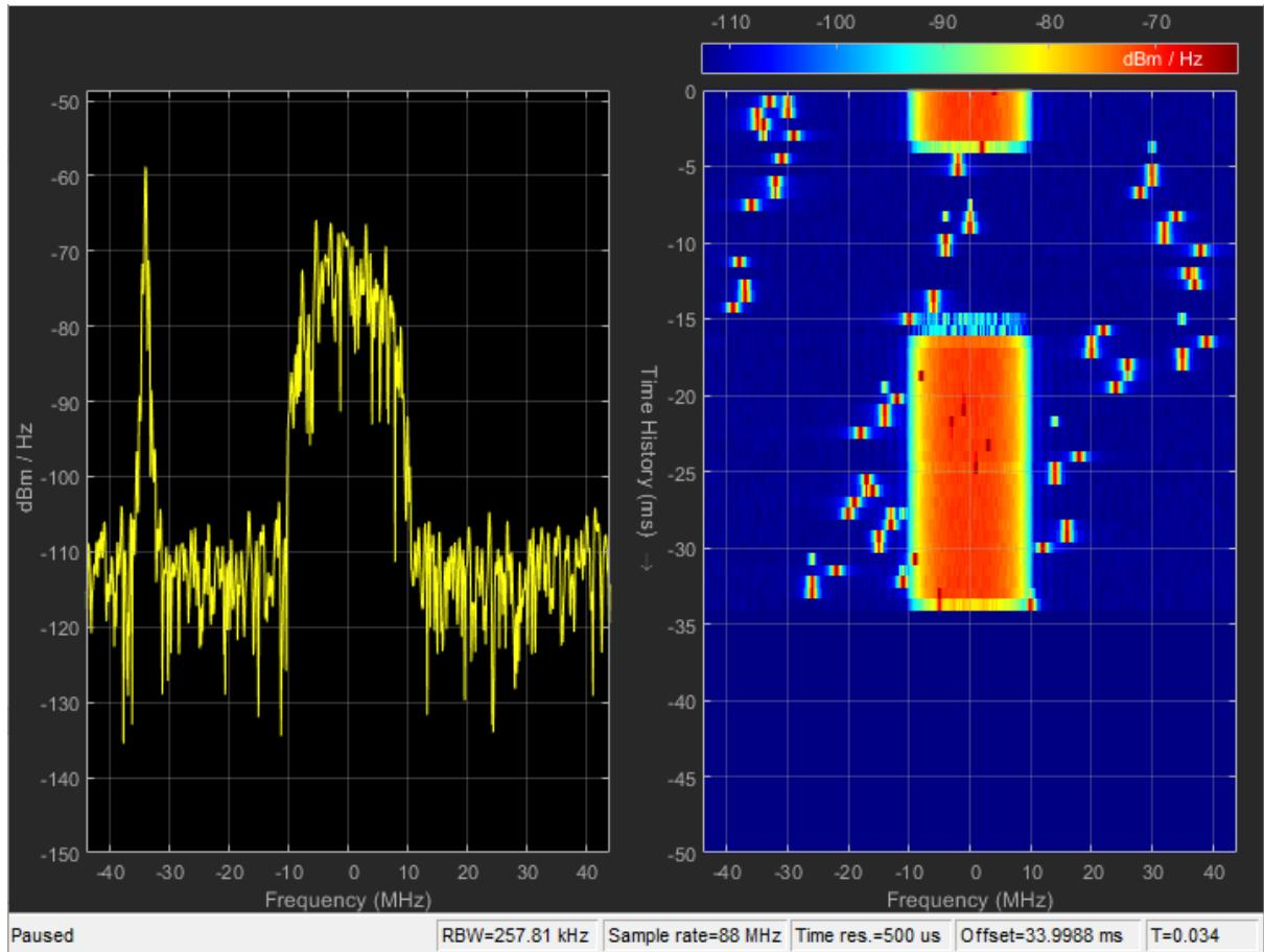
*Slika 5.31. Spektar primljenog signala te spektrogram kanala DMI/AWGN&802.11b/3&4*
