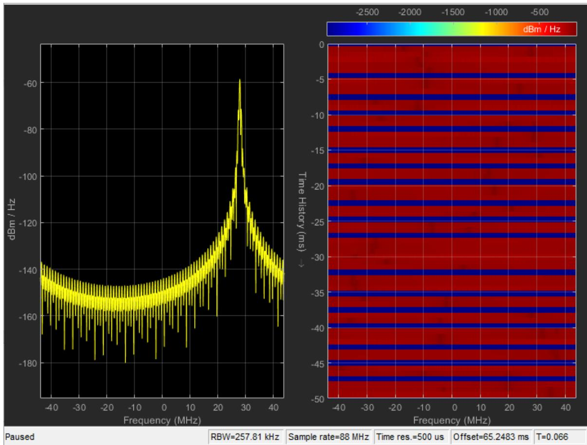
Slika 5.67. Spektar primljenog signala te spektrogram kanala HV2/None/3&4
