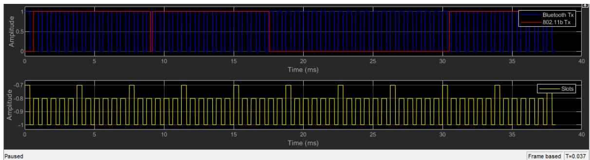
Slika 5.14. Vremenski dijagram primljenog signala HV1/AWGN&802.11b/1&2
