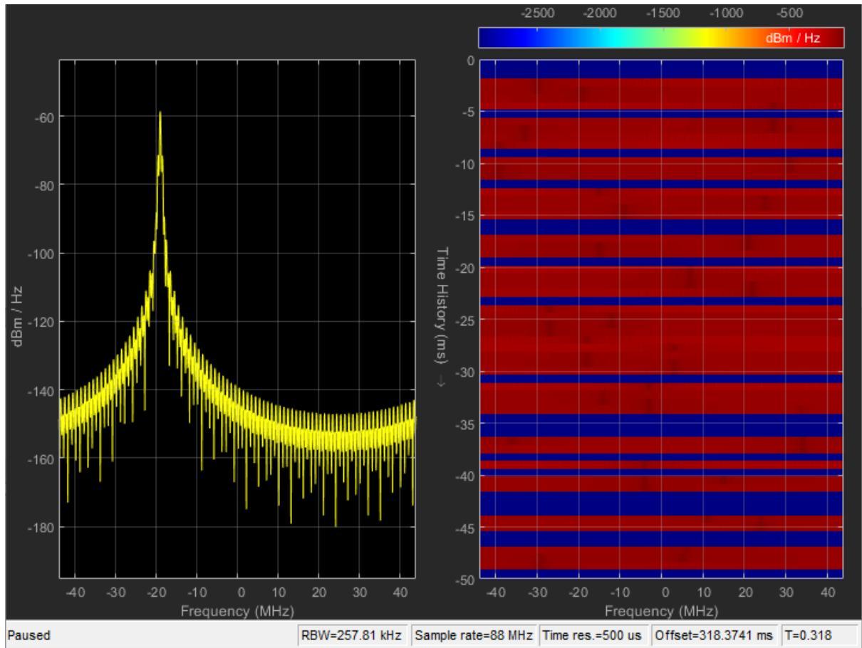
Slika 5.59. Spektar primljenog signala te spektrogram kanala HV3/None/1&2
