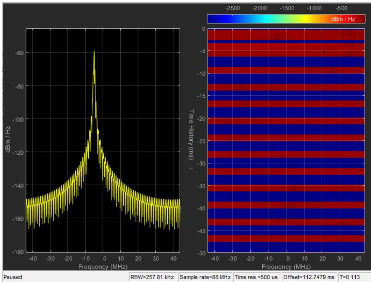
Slika 5.69. Spektar primljenog signala te spektrogram kanala HV3/None/3&4
