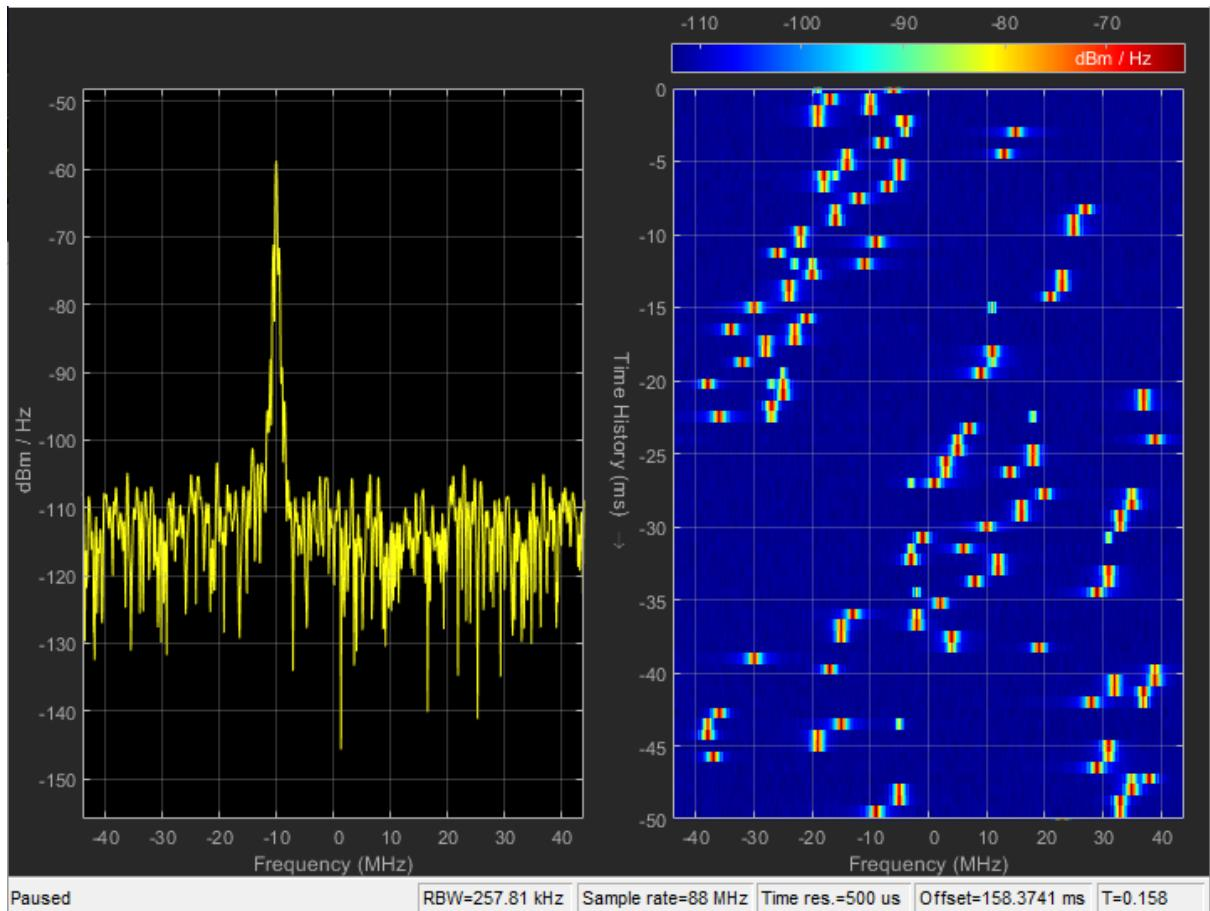
*4.43. Spektar primljenog signala te spektrogram kanala SCORT/AWGN/I&2*
