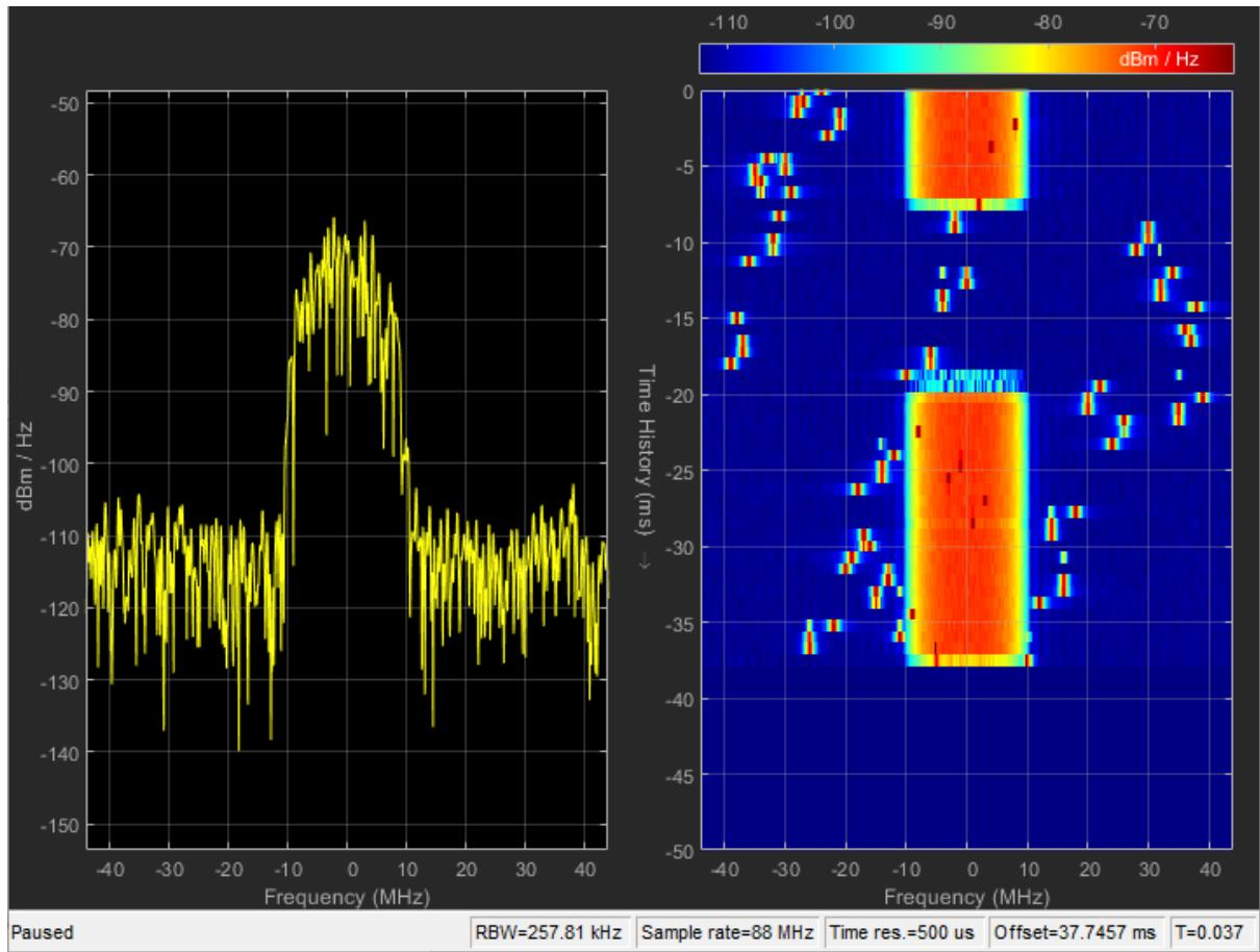
Slika 5.15. Spektar primljenog signala te spektrogram kanala HVI/AWGN&802.11b/I&2
