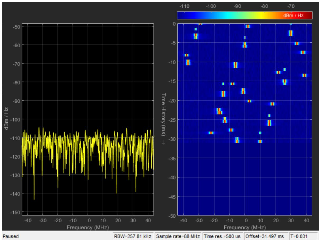
Slika 5.37. Spektar primljenog signala te spektrogram kanala HV2/AWGN/1&2
