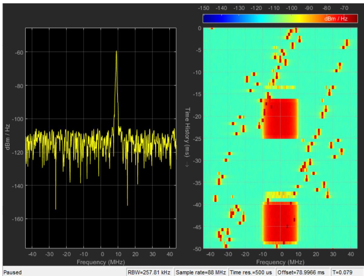
Slika 5.25. Spektar primljenog signala te spektrogram kanala HVI/AWGN&802.11b/3&4
