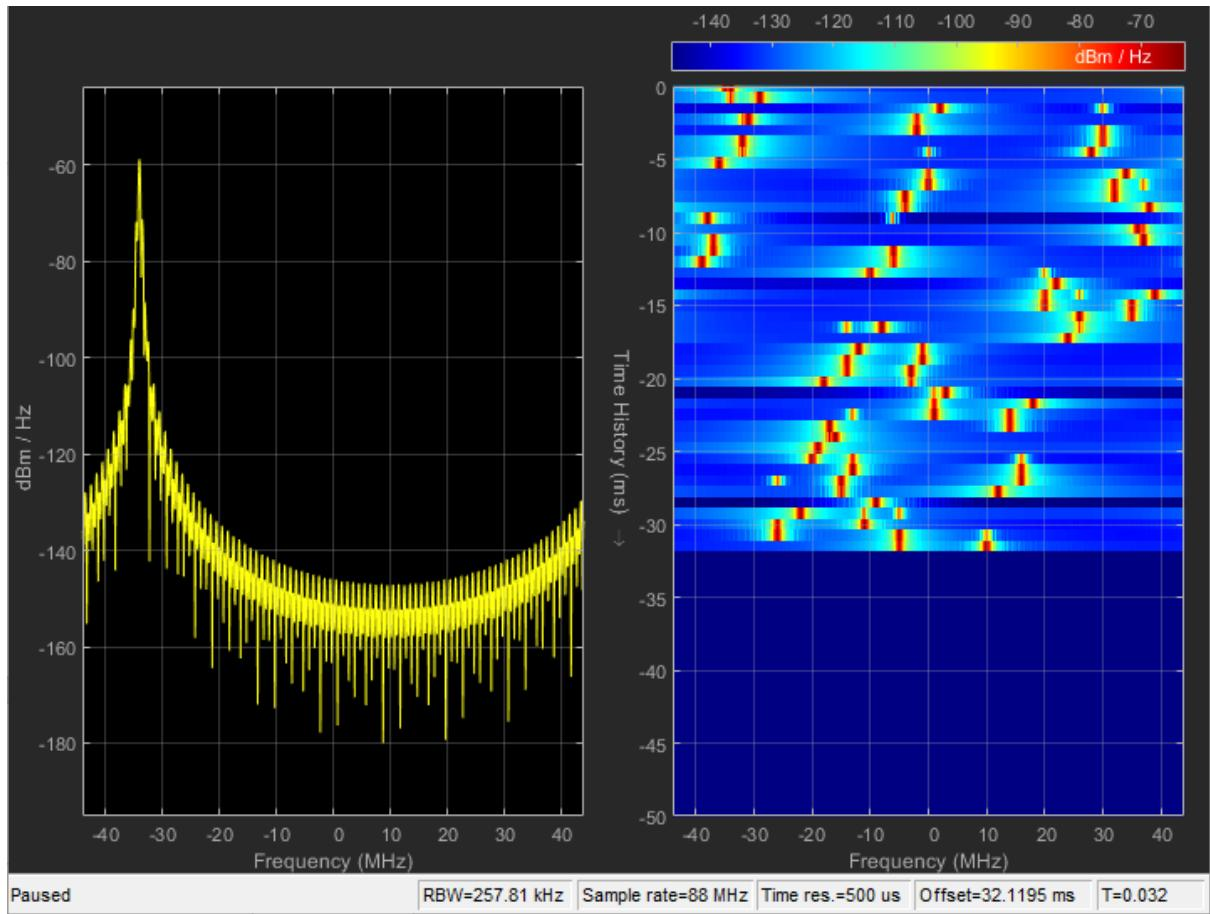
Slika 5.71. Spektar primljenog signala te spektrogram kanala DMI/None/3&4
