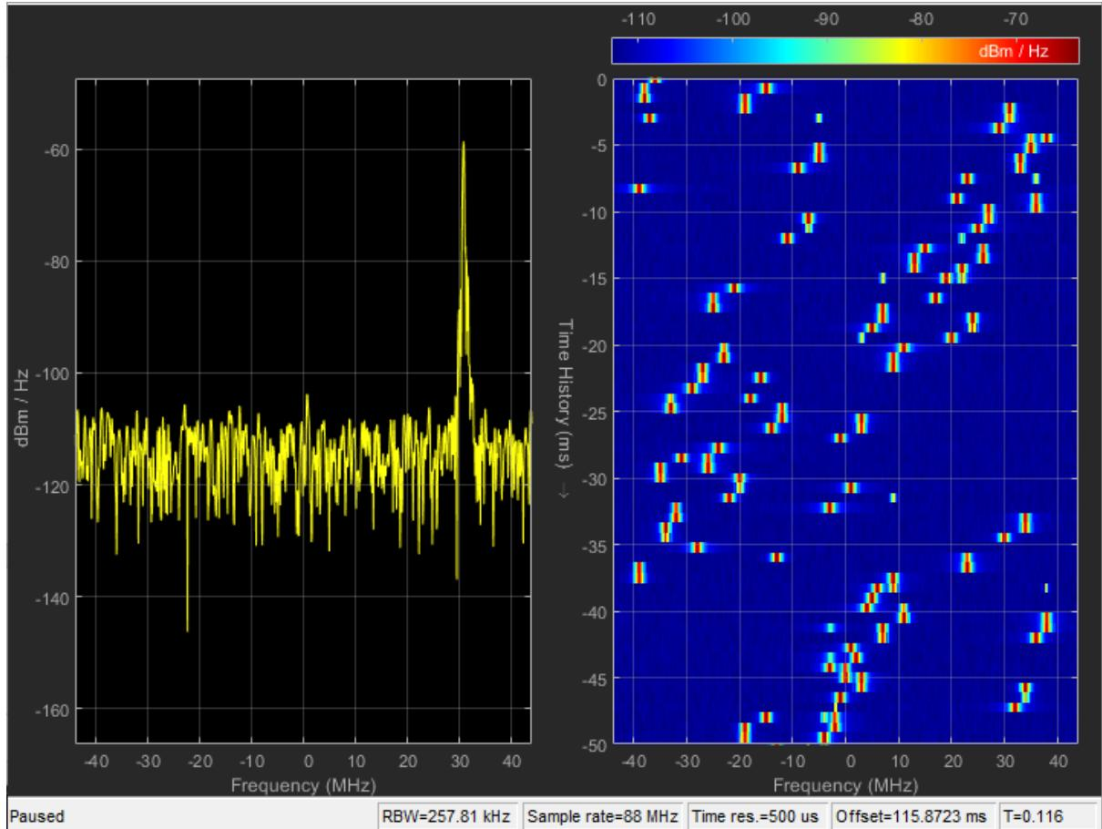
Slika 5.45. Spektar primljenog signala te spektrogram kanala HVI/AWGN/3&4
