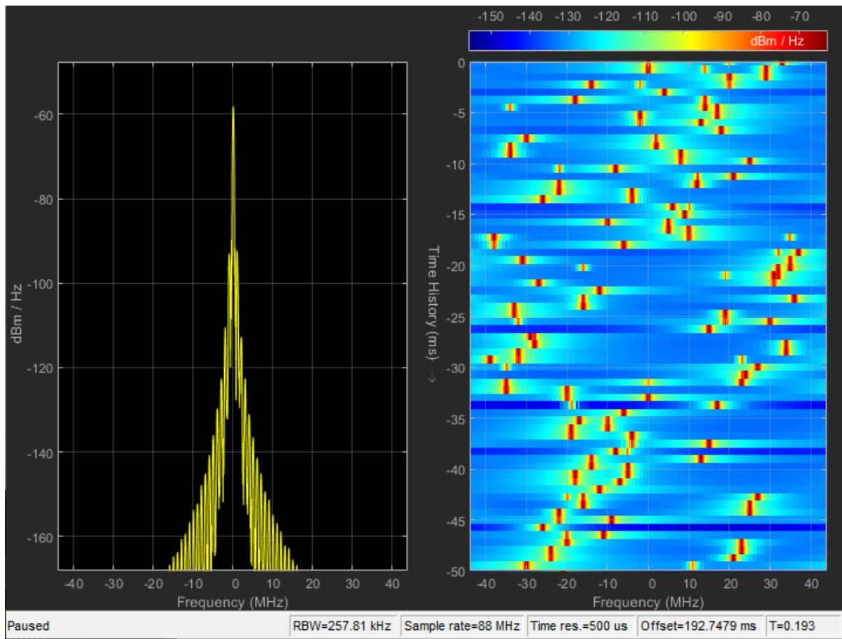
Slika 5.65. Spektar primljenog signala te spektrogram kanala HVI/None/3&4
