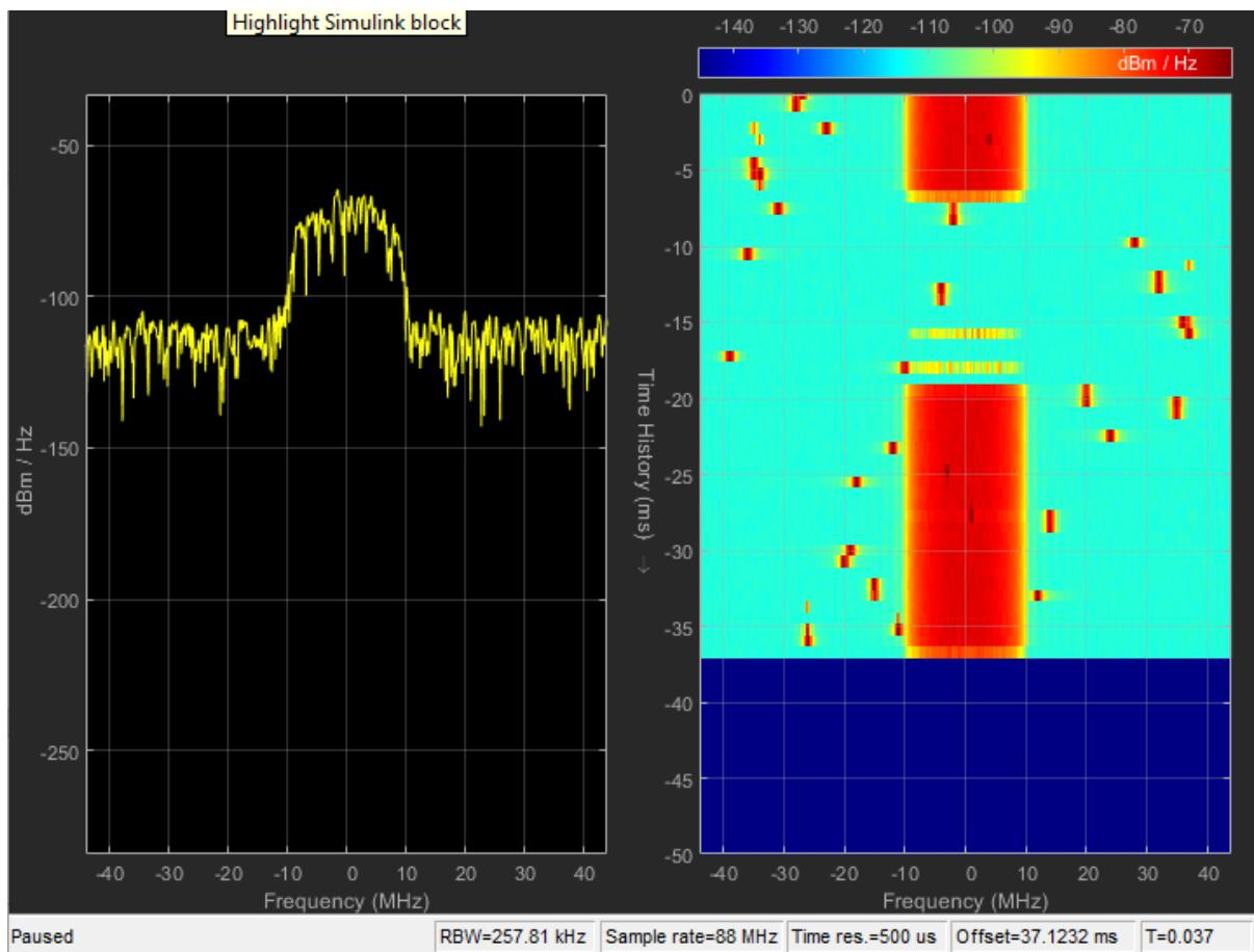
Slika 5.27. Spektar primljenog signala te spektrogram kanala HV2/AWGN&802.11b/3&4
