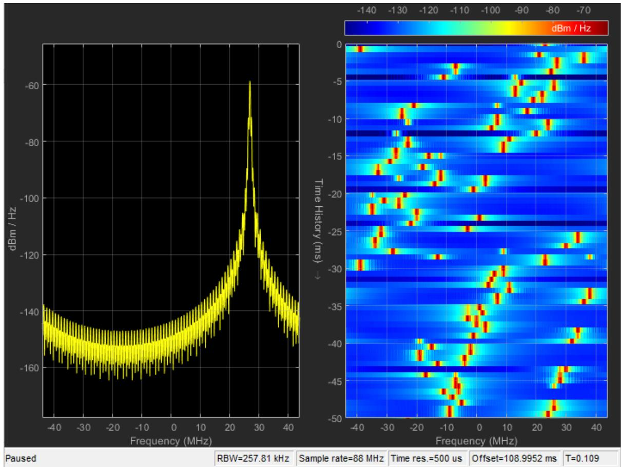
Slika 5.63. Spektar primljenog signala te spektrogram kanala SCORT/None/I&2
