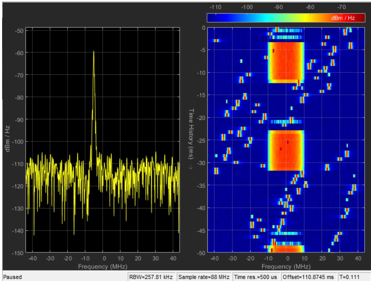
Slika 5.21. Spektar primljenog signala te spektrogram kanala DM1/AWGN&802.11b/1&2
