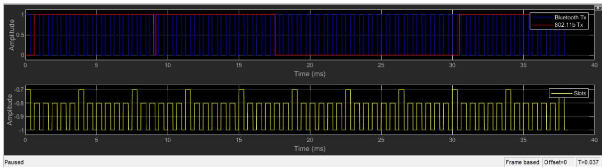
*Slika 5.32. Vremenski dijagram primljenog signala SCORT/AWGN&802.11b/3&4*
