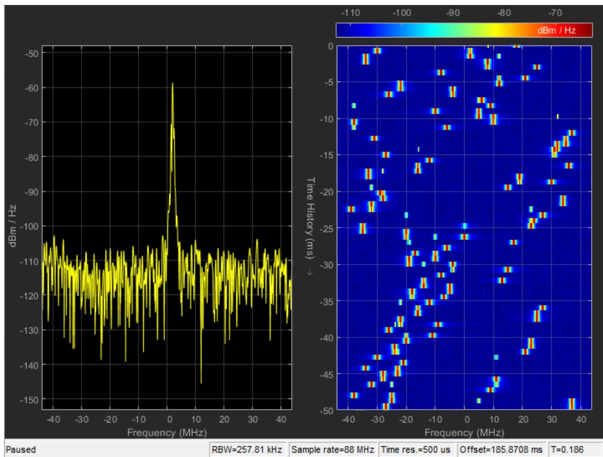
Slika 5.51. Spektar primljenog signala te spektrogram kanala DM1/AWGN/3&4
