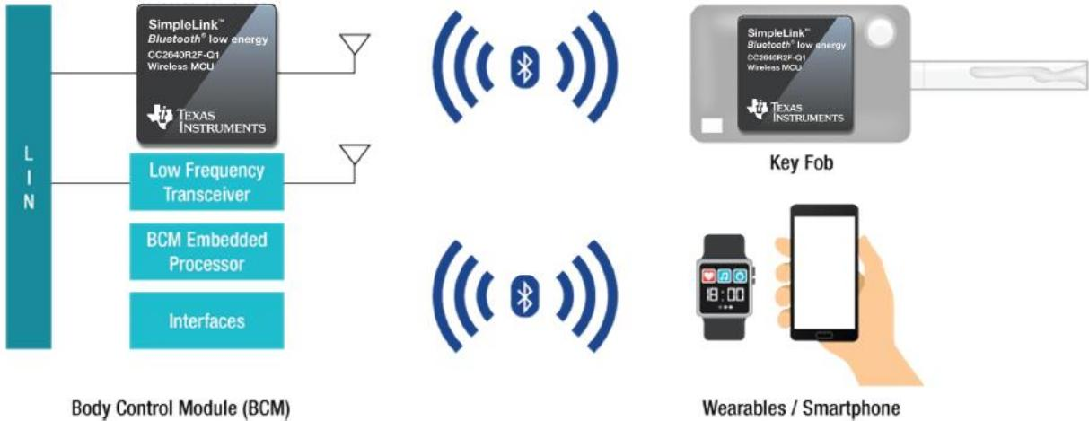
Slika 4.1. Blok dijagram pristupa automobilu korištenjem BLE aplikacije [25]
