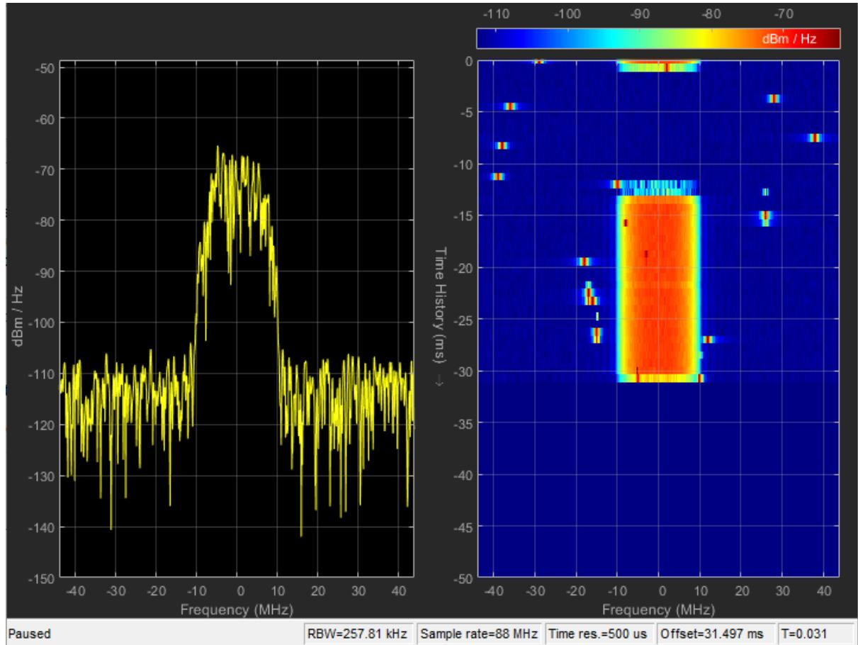
*Slika 5.19. Spektar primljenog signala te spektrogram kanala HV3/AWGN&802.11b/I&2*
