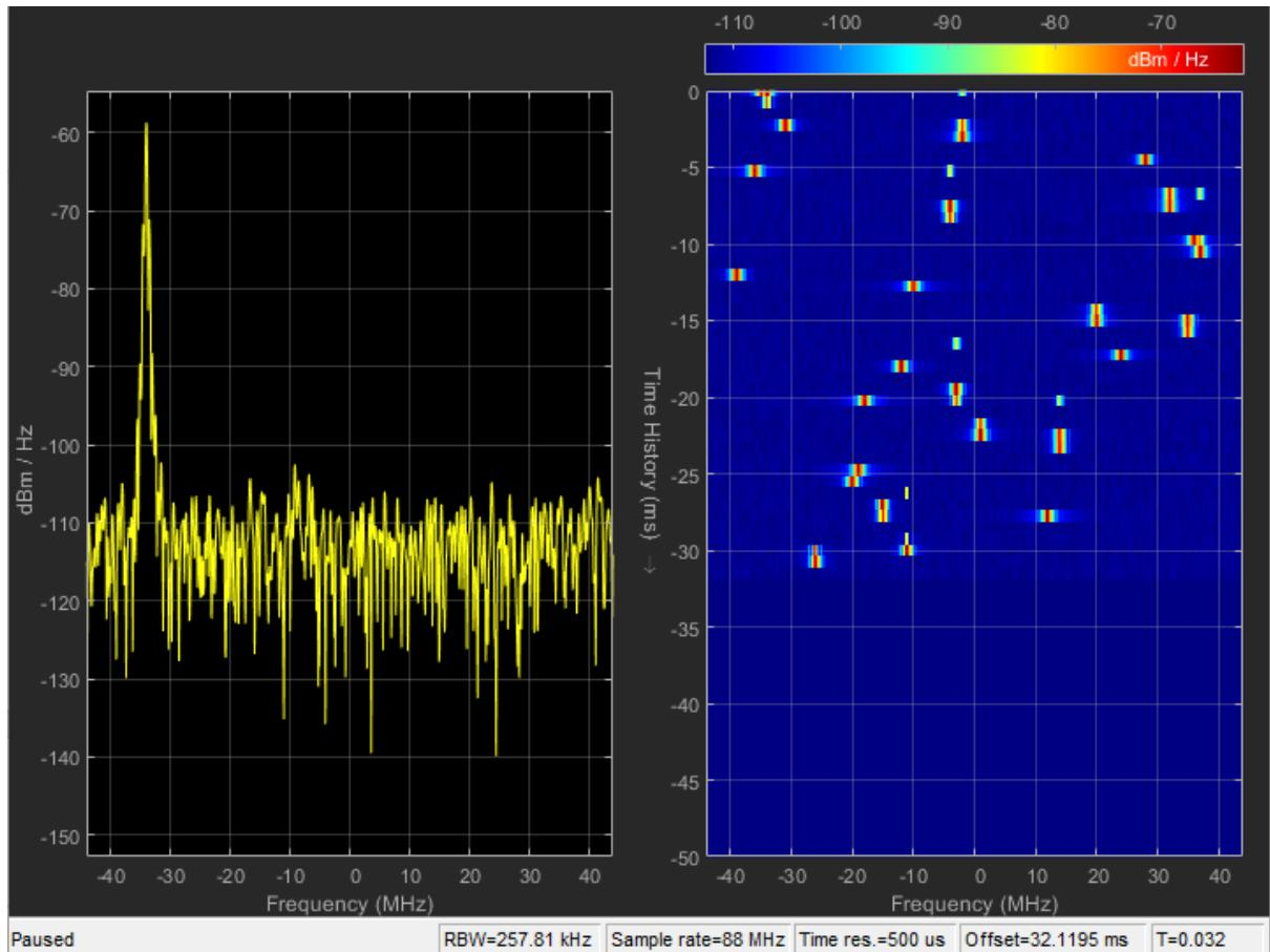
Slika 5.47. Spektar primljenog signala te spektrogram kanala HV2/AWGN/3&4
