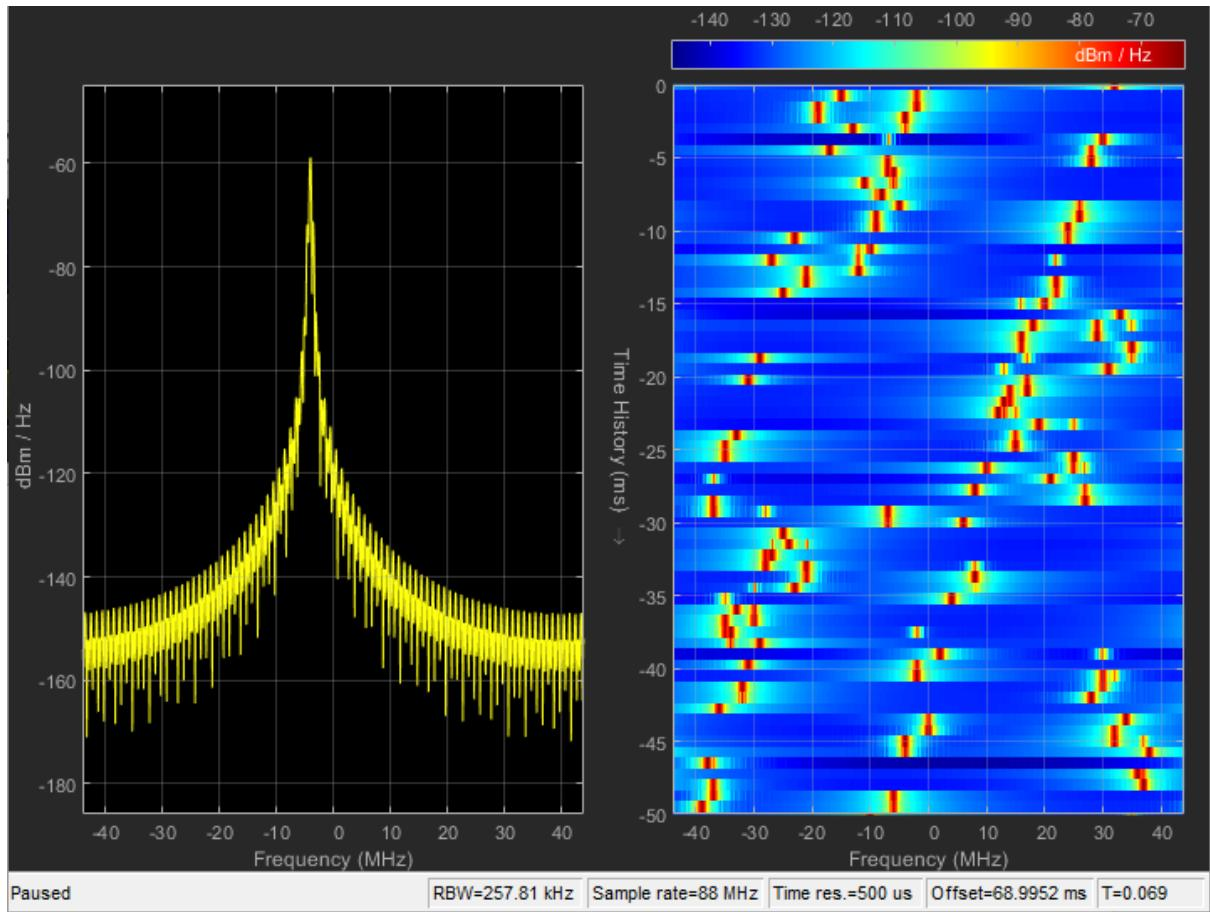
Slika 5.61. Spektar primljenog signala te spektrogram kanala DMI/None/1&2
