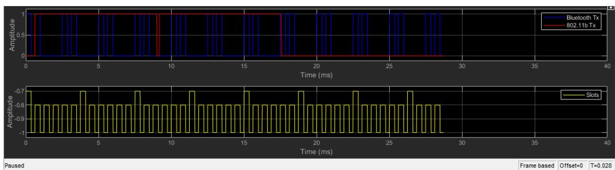
Slika 5.16. Vremenski dijagram primljenog signala HV2/AWGN&802.11b/I&2
