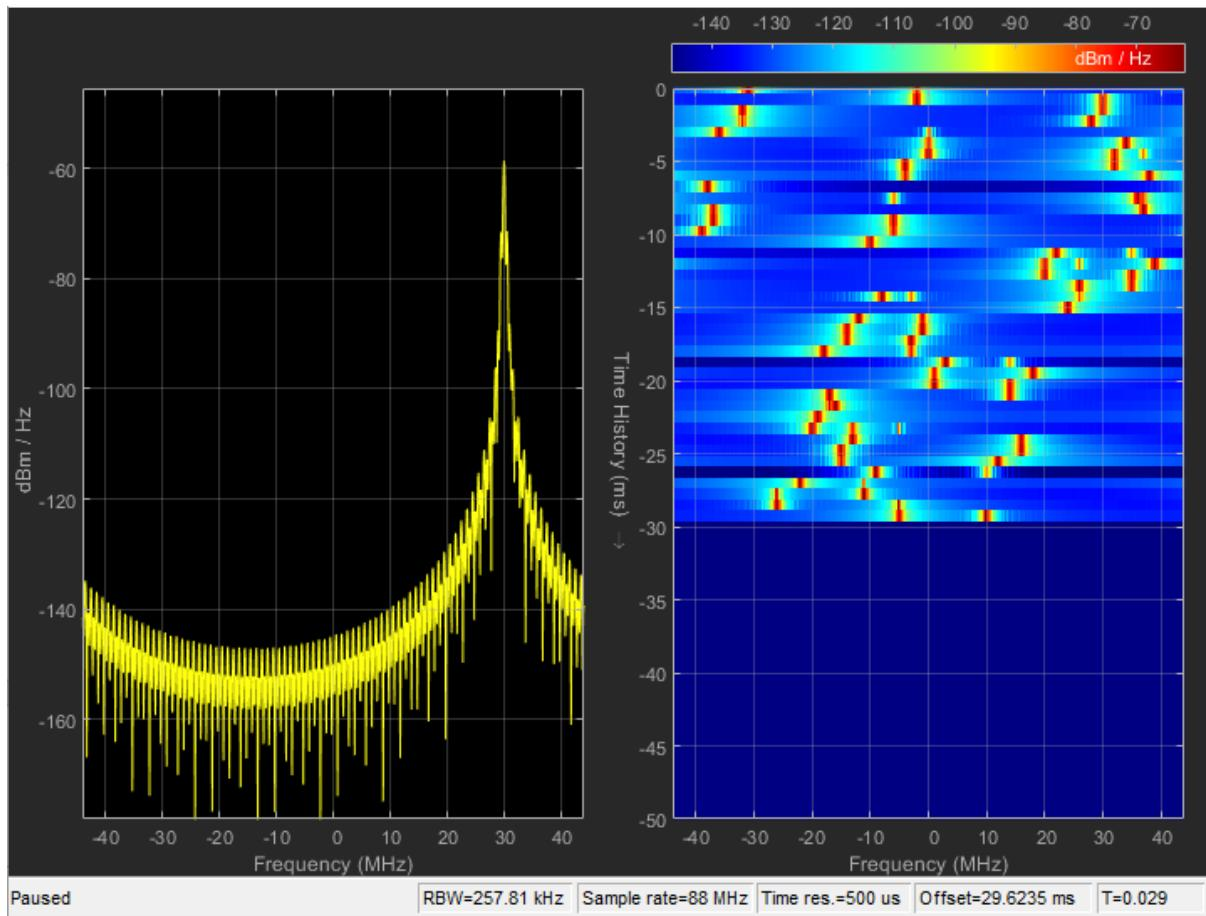
*Slika 5.73. Spektar primljenog signala te spektrogram kanala SCORT/None/3&4*
