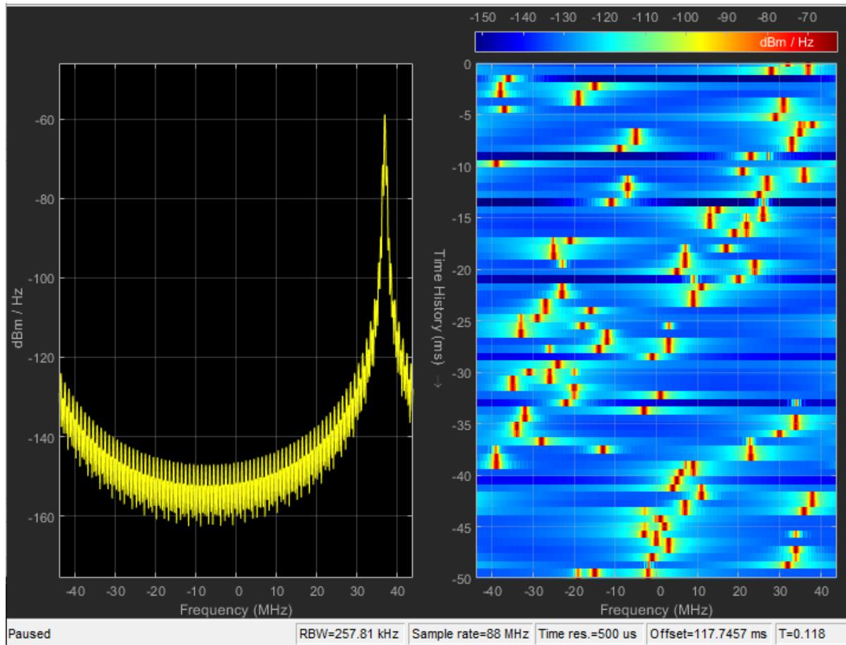
*Slika 5.55. Spektar primljenog signala te spektrogram kanala HV1/None/1&2*
