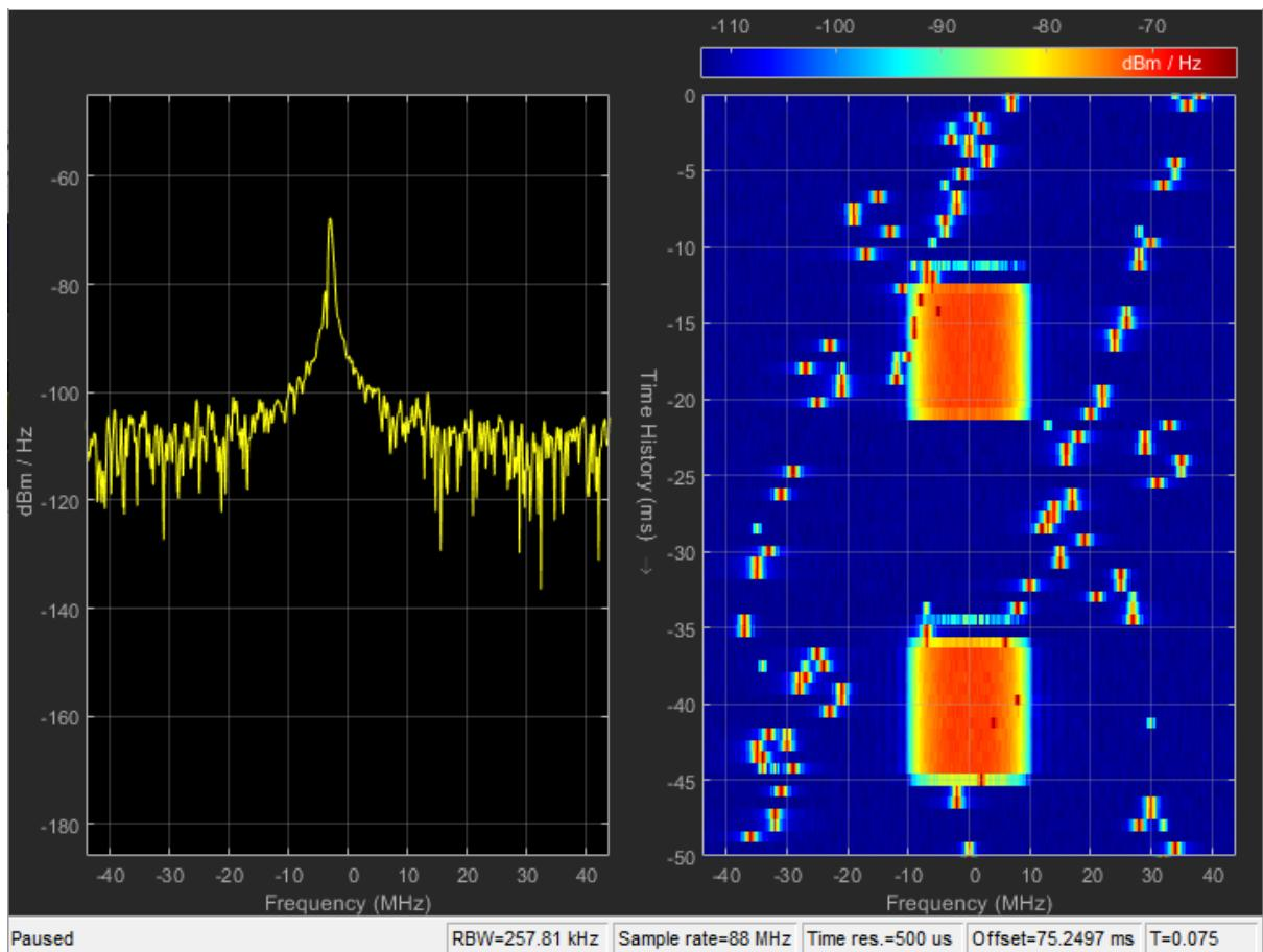
Slika 5.23. Spektar primljenog signala te spektrogram kanala SCORT/AWGN&802.11b/I&2
