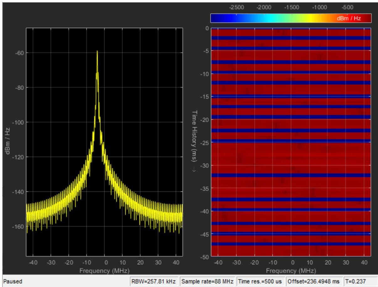
Slika 5.57. Spektar primljenog signala te spektrogram kanala HV2/None/1&2
