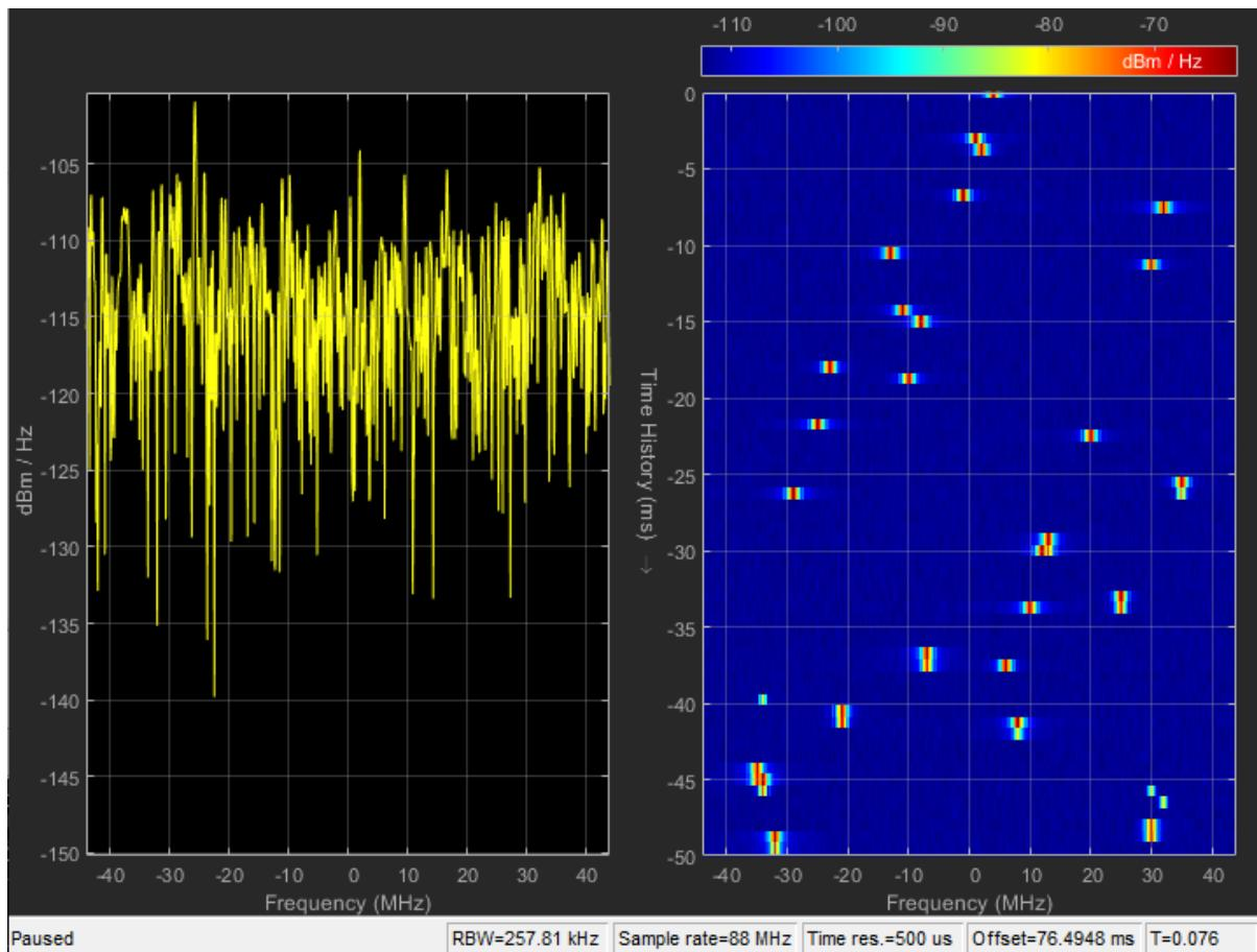
Slika 5.49. Spektar primljenog signala te spektrogram kanala HV3/AWGN/3&4
