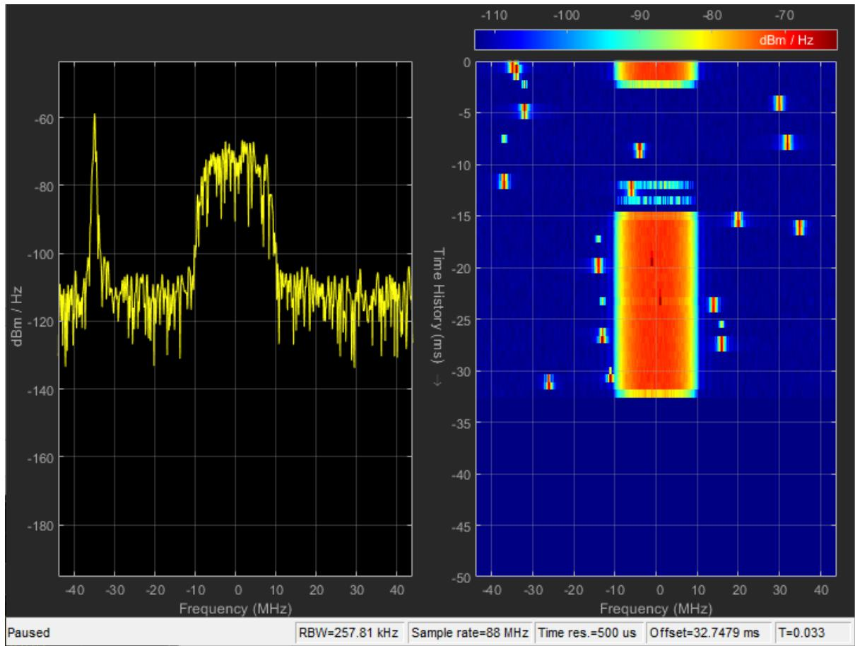
Slika 5.29. Spektar primljenog signala te spektrogram kanala HV3/AWGN&802.11b/3&4
