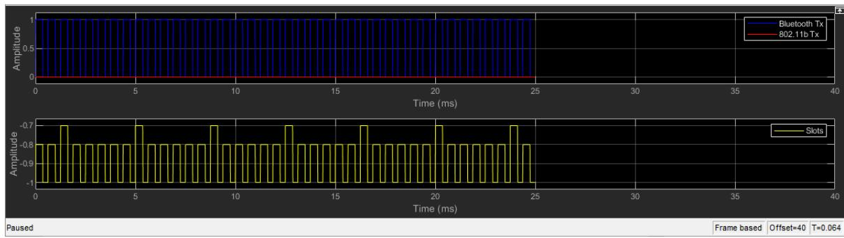
Slika 5.34. Vremenski dijagram primljenog signala HVI/AWGN/1&2
