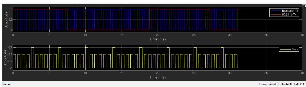
*Slika 5.20. Vremenski dijagram primljenog signala DM1/AWGN&802.11b/I&2*
