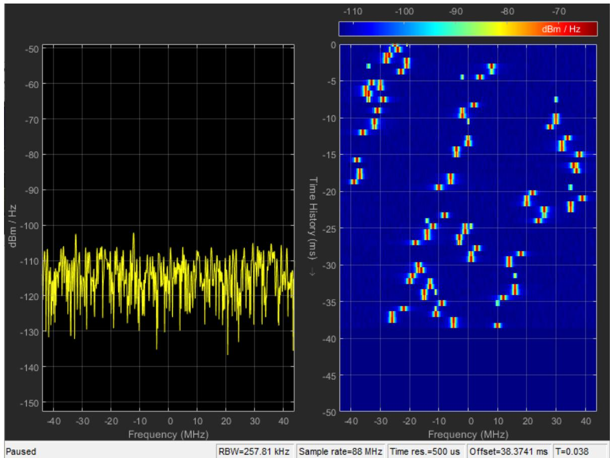
Slika 5.41. Spektar primljenog signala te spektrogram kanala DMI/AWGN/I&2
