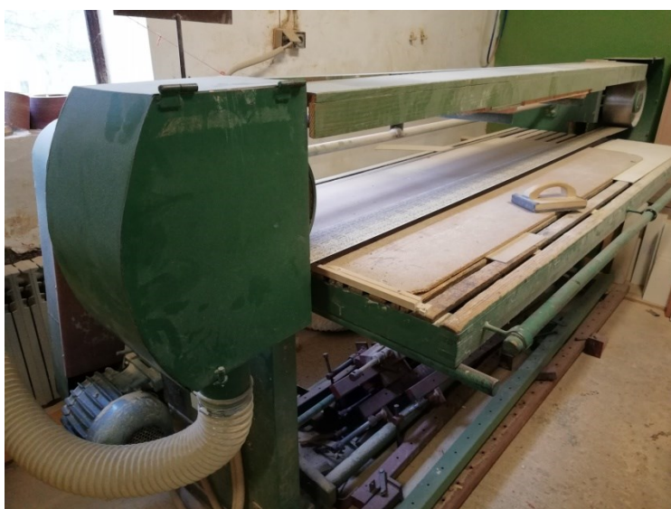
Slika 3.10. Horizontalna tračna brusilica (fotografirano 18.4.2018.)
