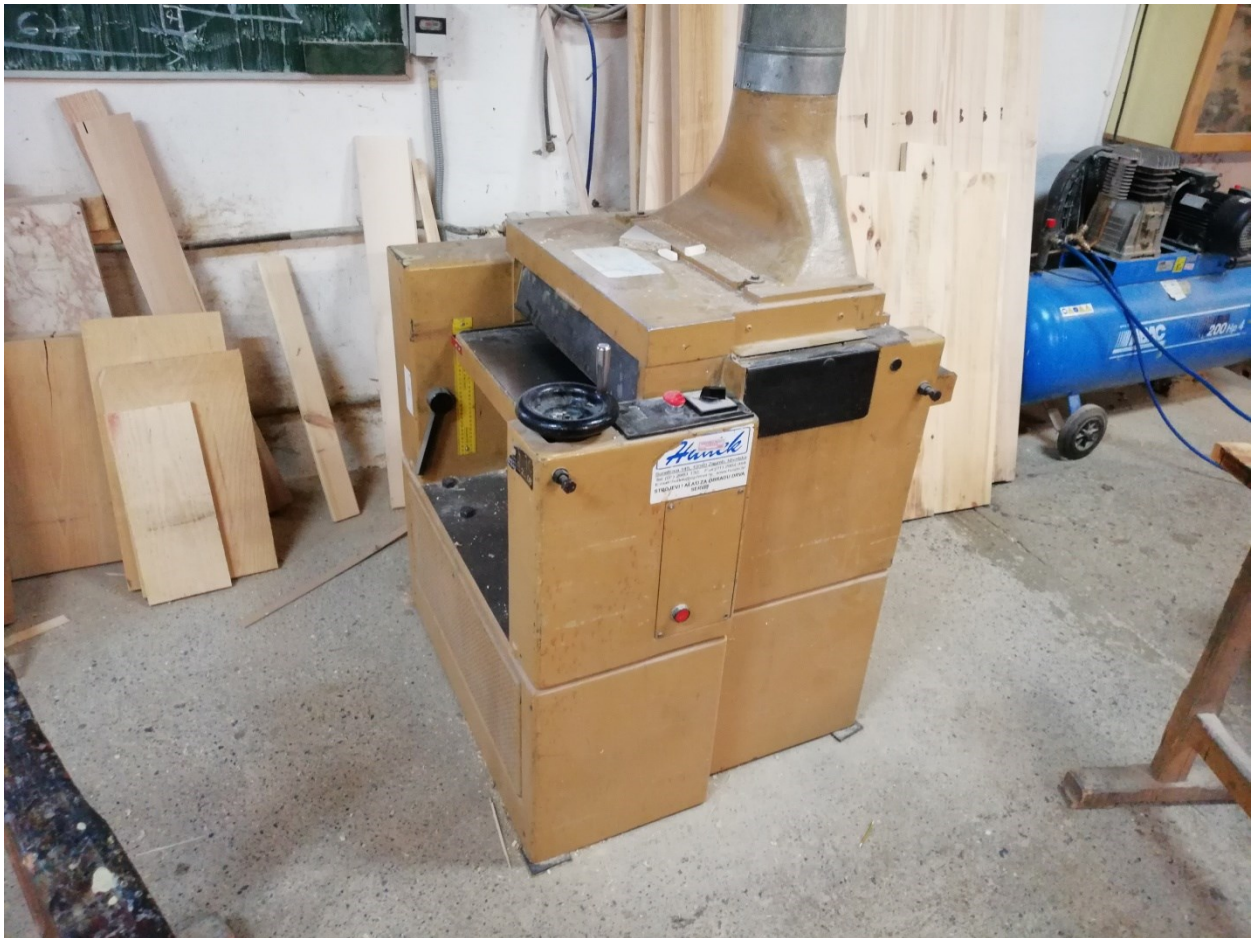
Slika 3.9. Debljača „SCM“ (fotografirano 18.4.2018.)
