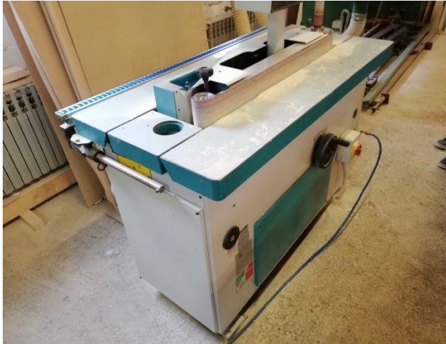
Slika 3.12. Vertikalna tračna brusilica (fotografirano 18.4.2018.)
