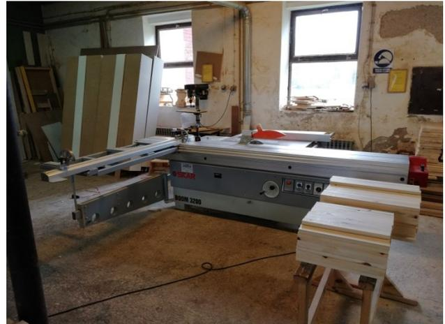
**Slika 3.19.** Formatna kružna pila „Sicar“
