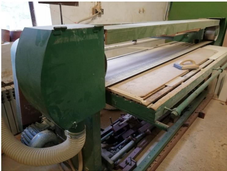
**Slika 3.10.** Horizontalna tračna brusilica
