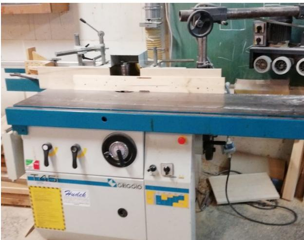
**Slika 3.14.** Stolna glodalica „Griggio T45i“
