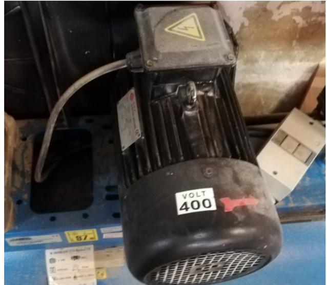
**Slika 3.5.** Pogonski motor kompresora
