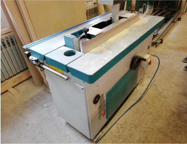
**Slika 3.12.** Vertikalna tračna brusilica
