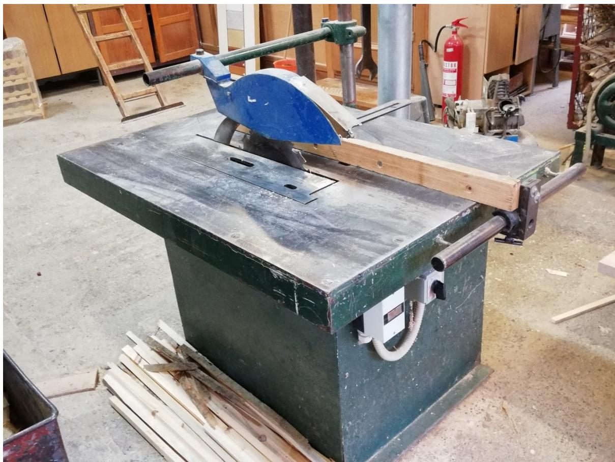
**Slika 3.17.** Kružna pila za uzdužno krojenje
