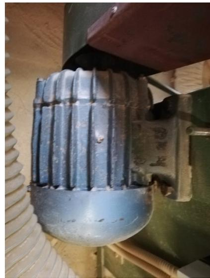
**Slika 3.11.** Pogonski motor brusilice
