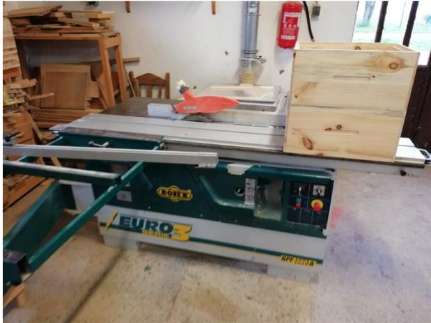
**Slika 3.18.** Formatna kružna pila „Euro 3“
