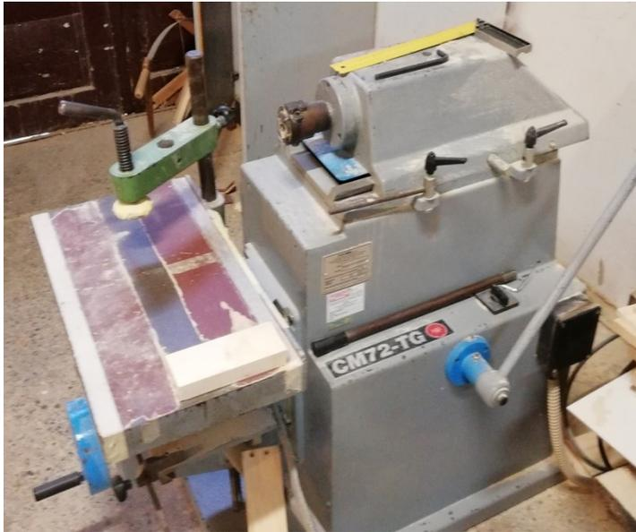
**Slika 3.20.** Vertikalna bušilica „CM72-TG“
