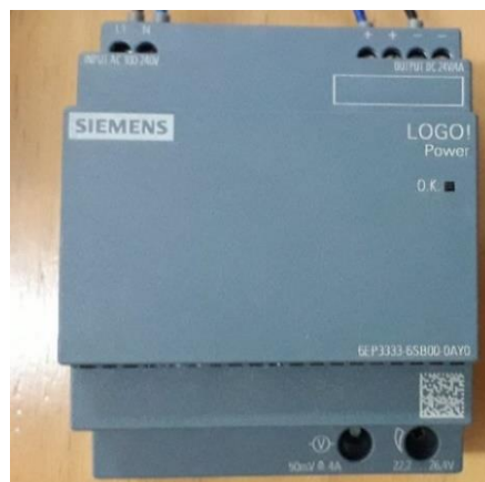
Slika 5.2 Siemens LOGO! Power 24V
