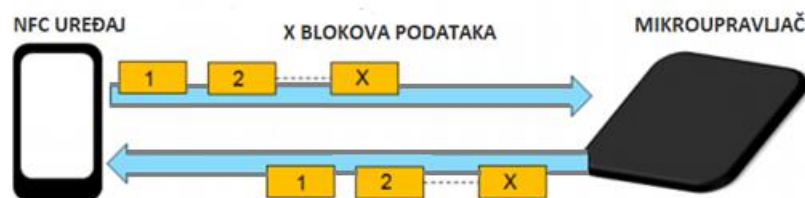
Sl. 5.5. Prikaz testiranja pass-through načina rada pomoću aplikacije NTAG I 2 C demo [11].
