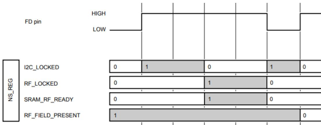
Sl. 5.7. Postupak prijenosa podataka *pass-through* načinom rada, s I<sup>2</sup>C prema NFC sučelju [25].
