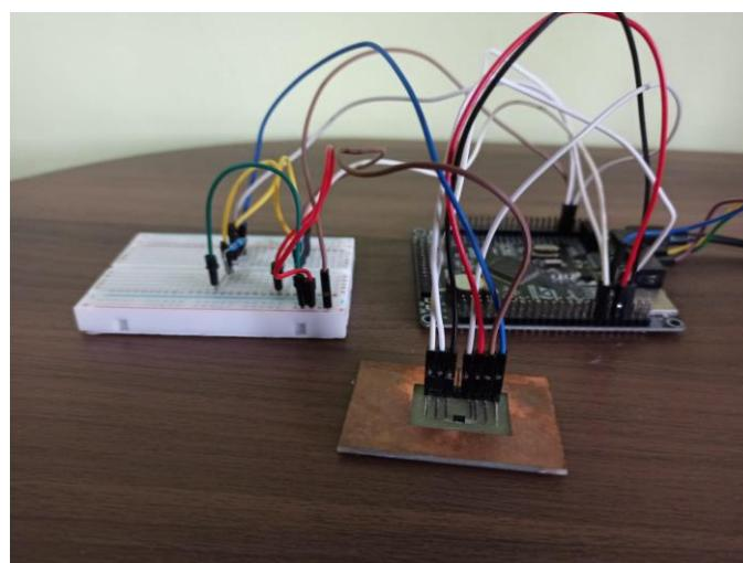
Sl. 5.2. Spajanje mikroupravljača s EEPROM-om prilikom testiranja.
