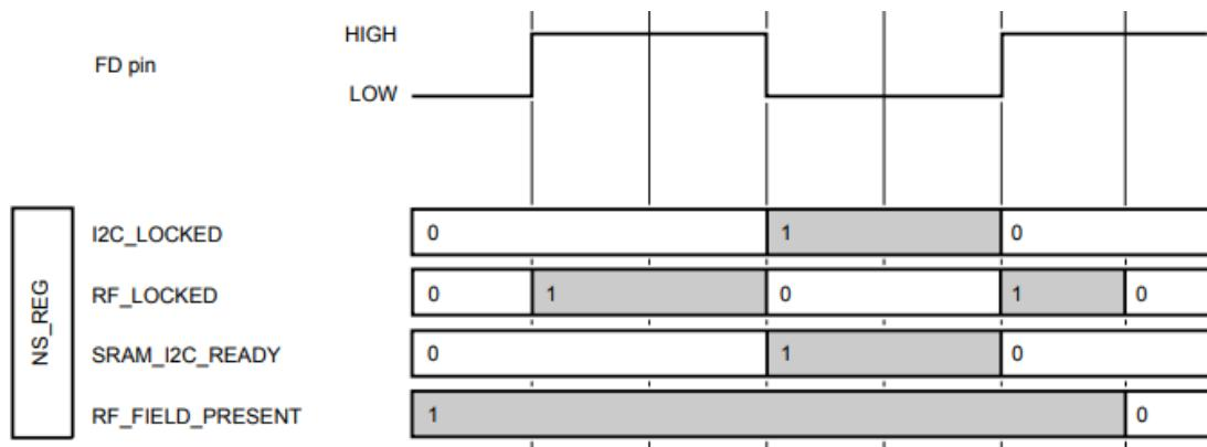
Sl. 5.6. Postupak prijenosa podataka *pass-through* načinom rada, s NFC prema I<sup>2</sup>C sučelju [25].
