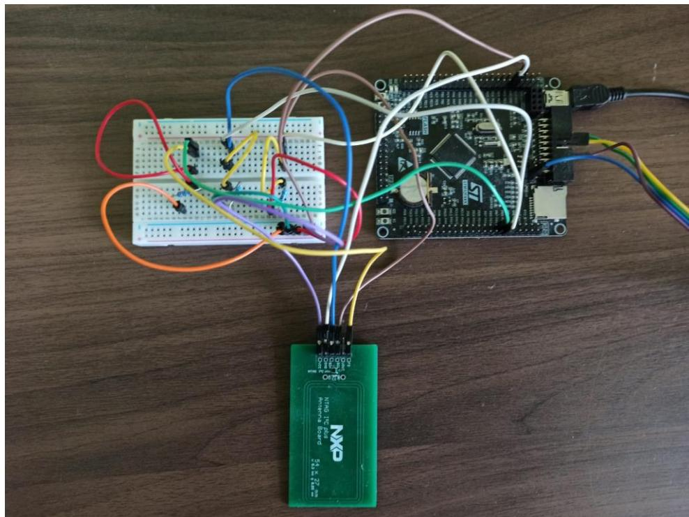
Sl. 5.4. Spajanje mikroupravljača s NT3H2211 prilikom testiranja.
