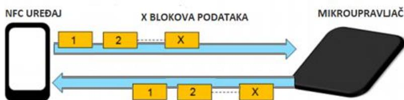
Sl. 5.5. Prikaz testiranja *pass-through* načina rada pomoću aplikacije NTAG I<sup>2</sup>C demo [11].
