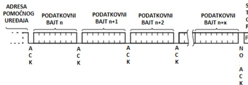
Sl. 4.10. Operacija sekvencijalnog čitanja bajta iz CAT24M01 [24].
