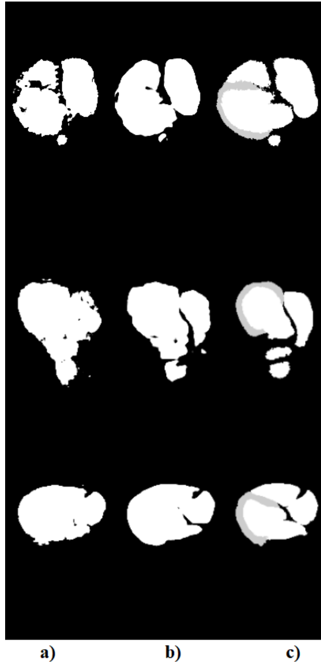
Slika 5.3 a) Segmentacija bez preobrade podataka b) Segmentacija sa preobradom podataka c) Originalne maske
