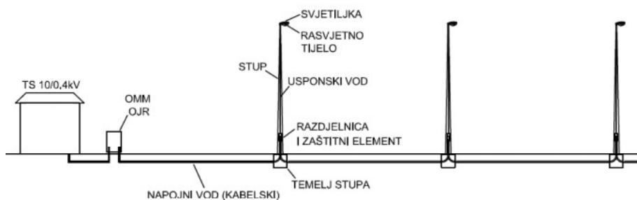
Slika 2.5 Elementi javne rasvjete nove generacije[46]
