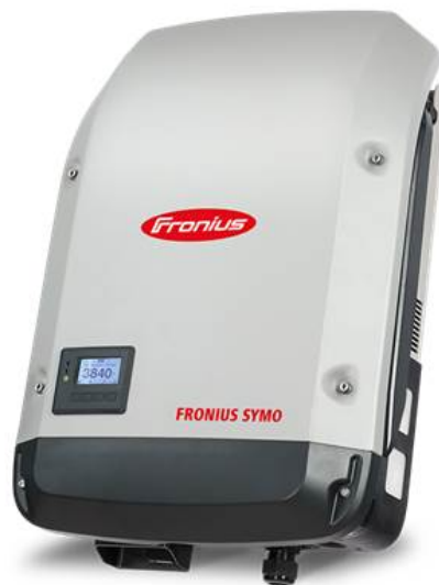
Slika 2.7. FRONIUS SYMO pretvarač [4]
