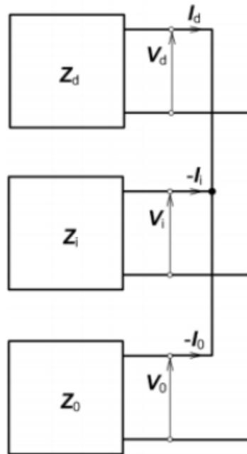
Slika 6.10. Ekvivalentna shema dvofaznog kratkog spoja sa zemljom
