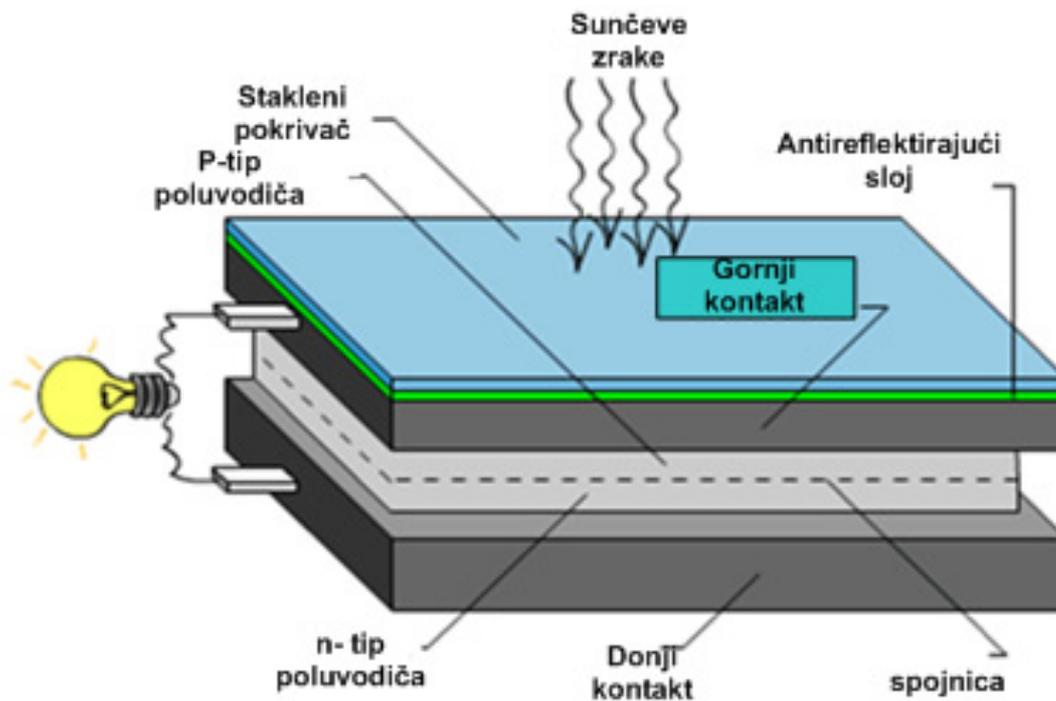
Slika 2.1. Osnovni dijelovi fotonaponske ćelije [1]
