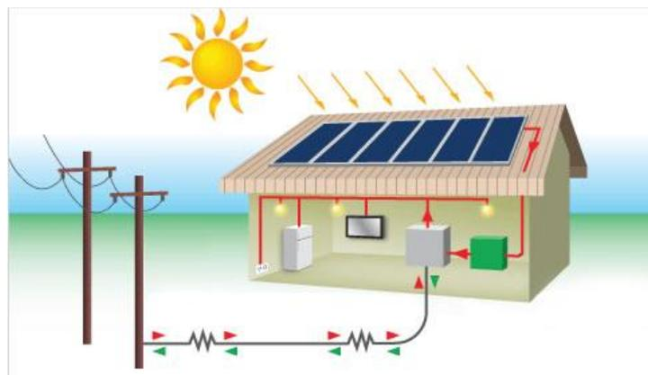
Slika 2.5. Fotonaponski sustav spojen na mrežu preko potrošača [3]
