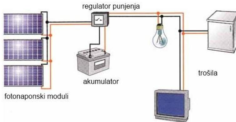
Slika 2.4. Autonomni fotonaponski sustav [3]
