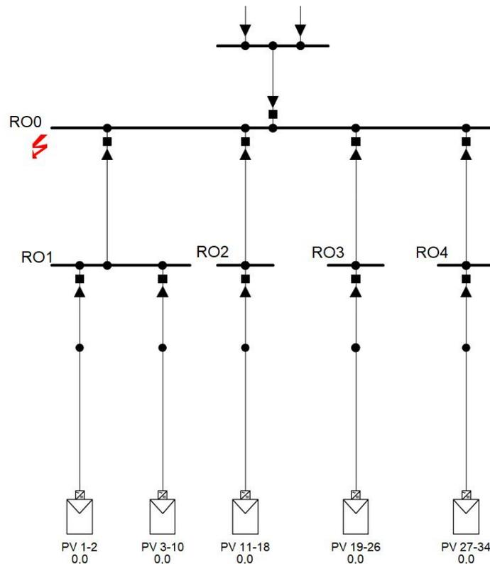
Slika 6.21. Trofazni kratki spoj u razvodnom ormaru RO0
