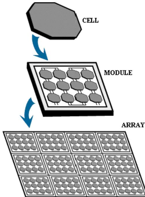
Slika 2.3. Fotonaponska ćelija, modul i niz [1]
