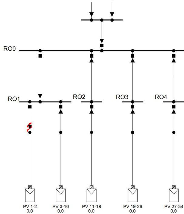
Slika 6.13. Kratki spoj na izlazu iz invertera PV 1-2
