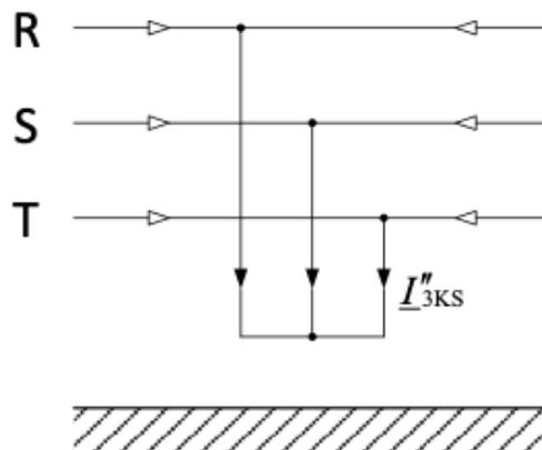
Slika 6.4. Shematski prikaz trofaznog kratkog spoja
