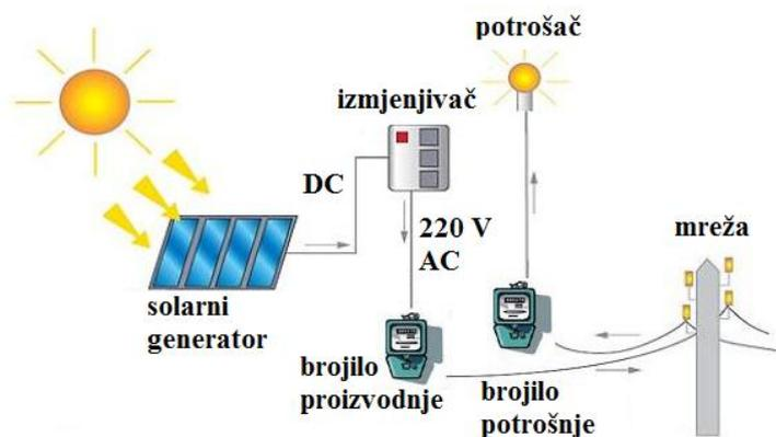
Slika 2.6. Fotonaponski sustav izravno spojen na mrežu [3]
