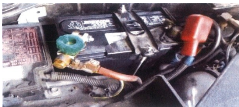
Slika 3.3.1. Ugradnja prekidača za automobilski akumulator
