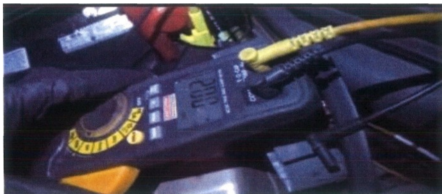
Slika 4.1.2. Struja parazitne potrošnje 20mA(Mercedes E 220)
