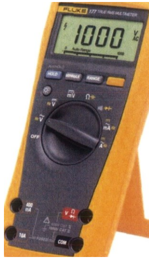
Slika 3.2.1. Digitalni multimeter Fluke 177, izvor [13]
