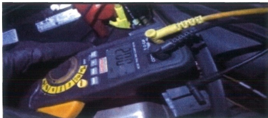
Slika 4.1.2. Struja parazitne potrošnje 20mA(Mercedes E 220)
