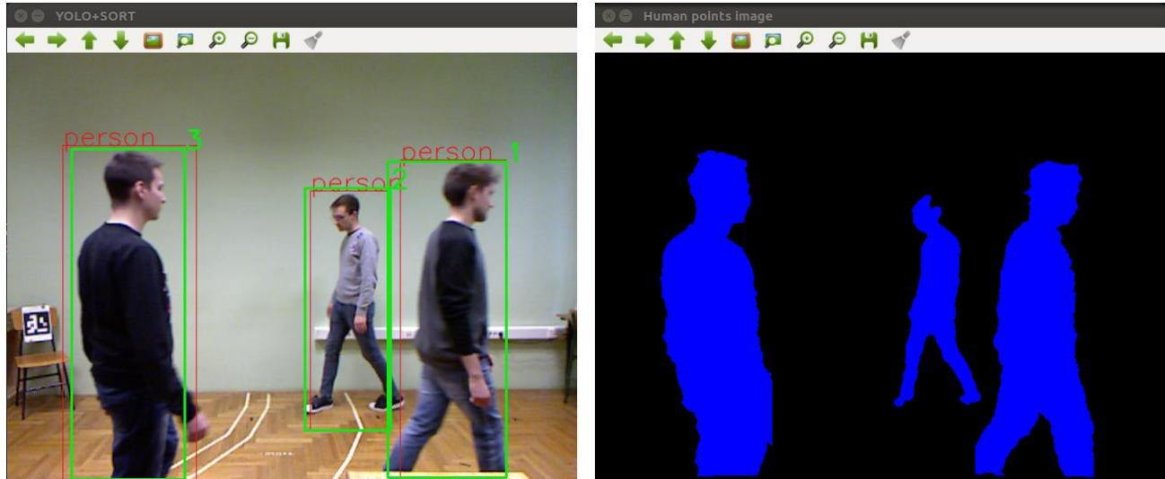
Slika 5.15. Detekcija ljudi na RGB slici (lijevo) i estimacija čovjeka na dubinskoj slici (desno)
