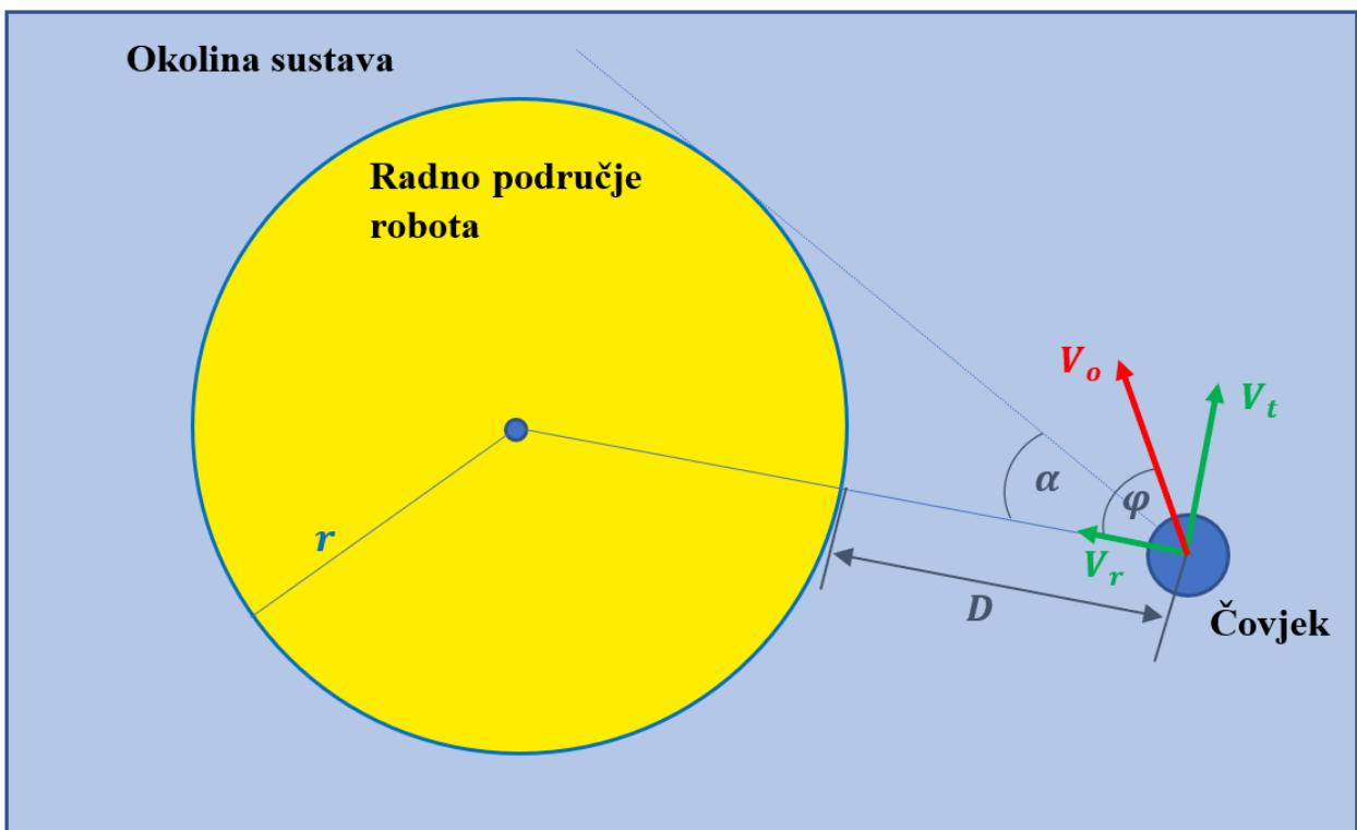
Slika 3.2. Shematski prikaz radnog okruženja robotskog sustava
