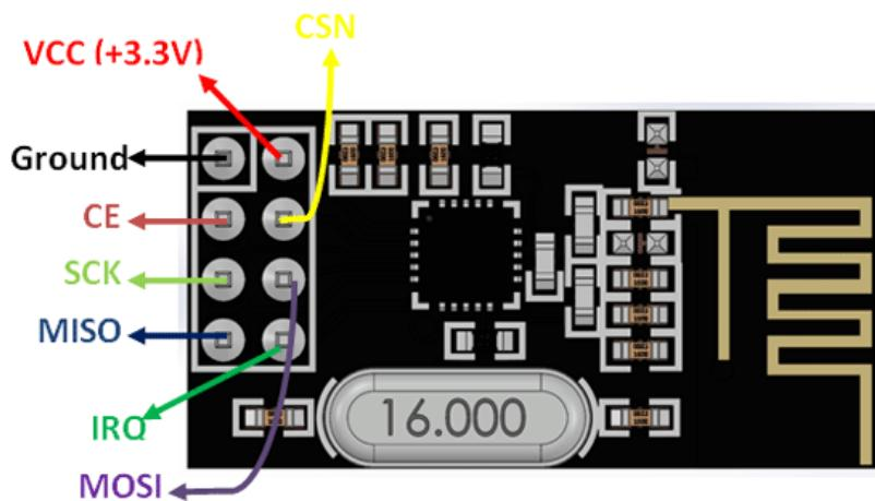
Slika 3.6. Prikaz nRF24L01 primopredajnika s pripadajućim priključcima.
