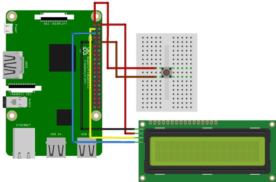
Slika 4.12. Shematski prikaz spajanja Raspberry Pi-a.
