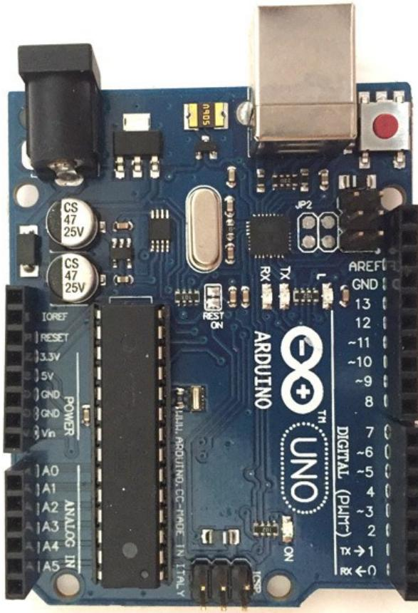
Slika 3.4. Prikaz Arduino UNO R3 mikrokontrolera s pripadajućim ulazima i izlazima [10].
