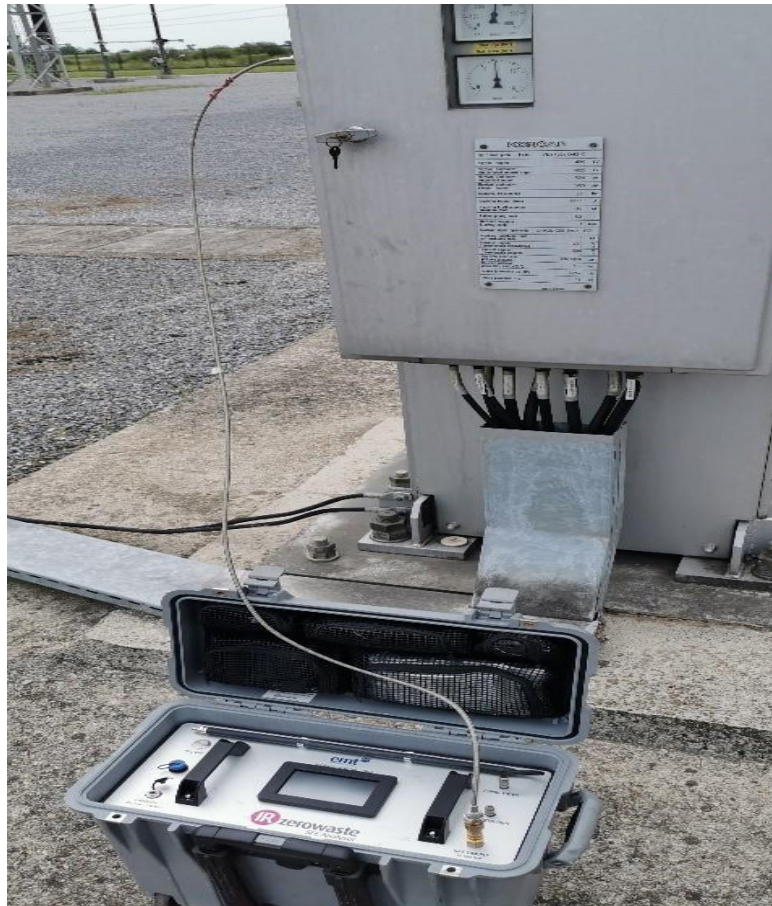
Slika 5.8. Uređaj za mjerenje kvalitete SF 6 plina EMT zerowaste SF 6 analyser
