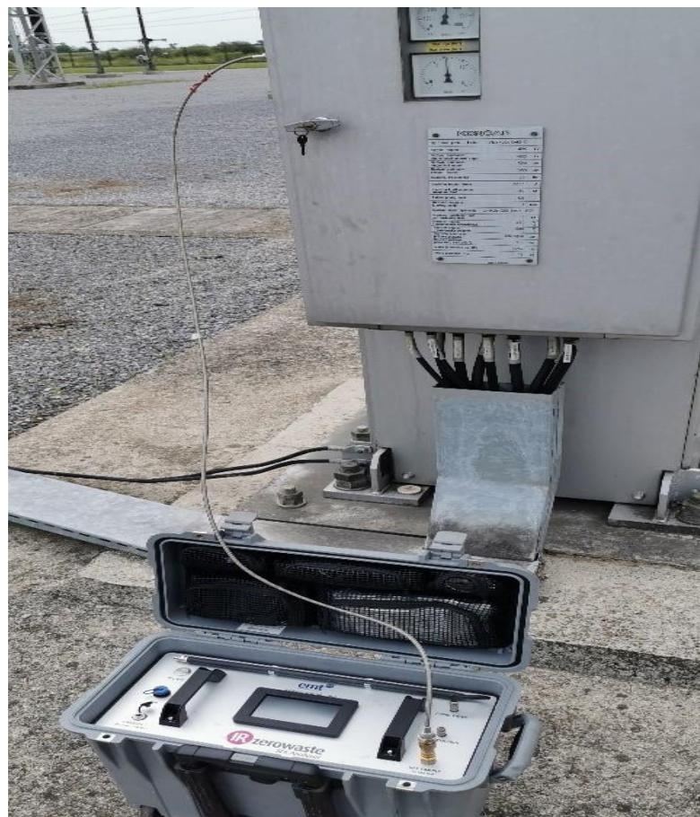
Slika 5.8. Uređaj za mjerjenje kvalitete SF<sub>6</sub> plina EMT zerowaste SF<sub>6</sub> analyser
