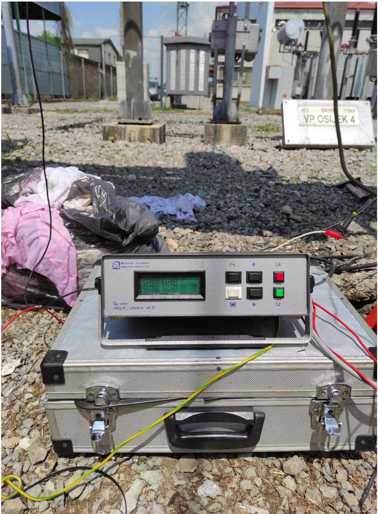
Slika 5.4. Uređaj za mjerjenje vremena uklopa i isklopa prekidača Elvira v6.0
