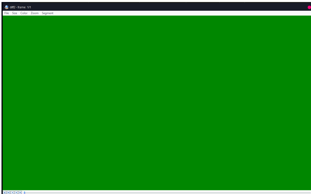
Slika 4.7. Slika dobivena oduzimanjem slike dobivene u programskom jeziku C na računalu i na Alpha ploči korištenjem interpolacije metodom najbližih susjeda – potvrda da rješenje implementirano na ploči daje rezultat identičan onome implementiranom na PC-u
