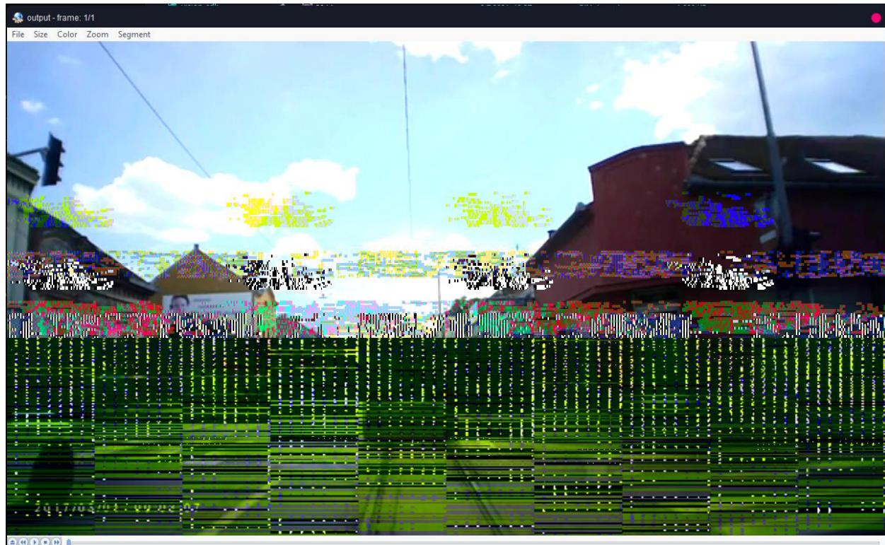
**Slika 4.23.** Primjer lošeg rezultata bikubične interpolacije prilikom istovremenog korištenja procesora A15, DSPI i DSP2; Slika prikazuje slučajne vrijednosti iz memorije
