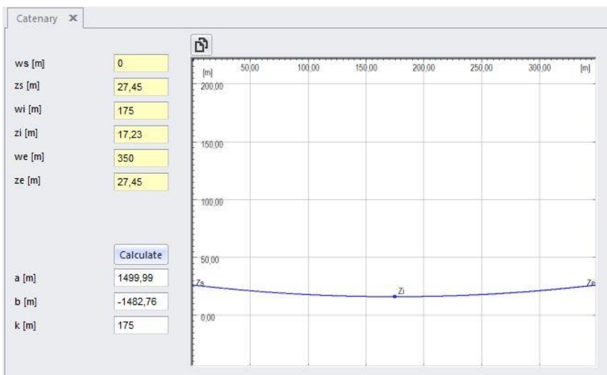
Slika 5.4. Izračun provjesa vodiča dalekovoda
