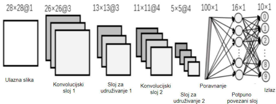
Slika 3.1 - Struktura konvolucijske neuronske mreže [19]
