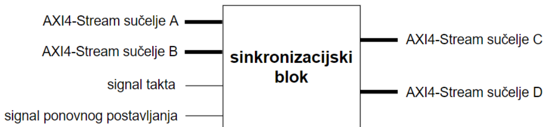
Slika 5.10 – Sinkronizacijski blok s pripadajućim ulazima i izlazima
