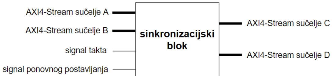
Slika 5.10 – Sinkronizacijski blok s pripadajućim ulazima i izlazima
