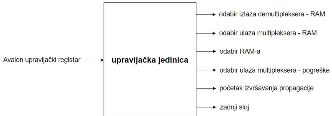
Slika 5.26 - Modul upravljачka jedinica s pripadajućim ulazima i izlazima
