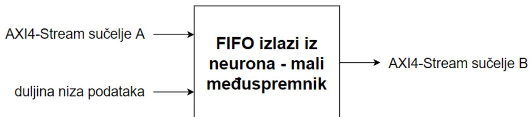
Slika 5.22 - Modul FIFO izlazi iz neurona - mali međuspremnik s pripadajućim ulazima i izlazima
