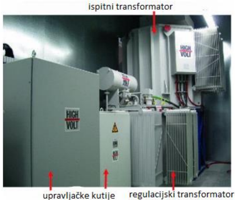
Slika 5.7. Slika prikazuje sobu za napajanje. [1]
