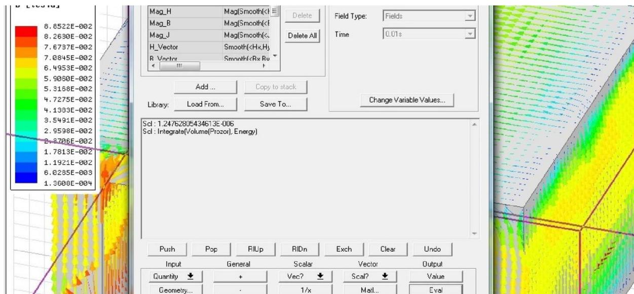
Slika P 6.73 Vrijednost energije rasipnog magnetskog polja  $W_\sigma$  ogrnutog transformatora
