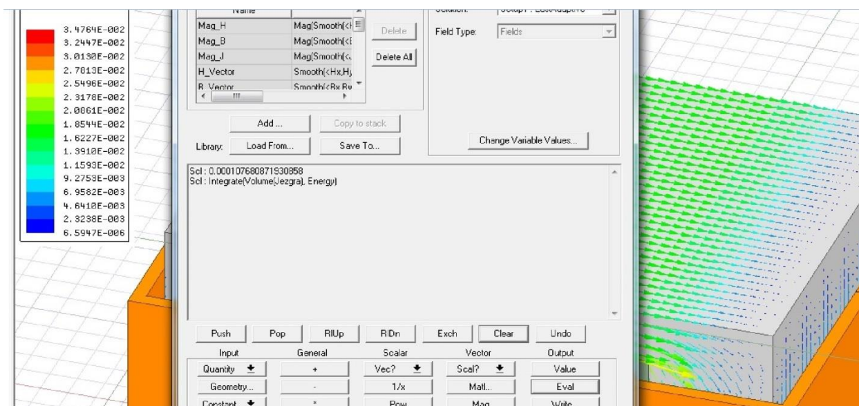
Slika P 6.75 Vrijednost energije glavnog magnetskog polja W_\mu jezgrog transformatora
