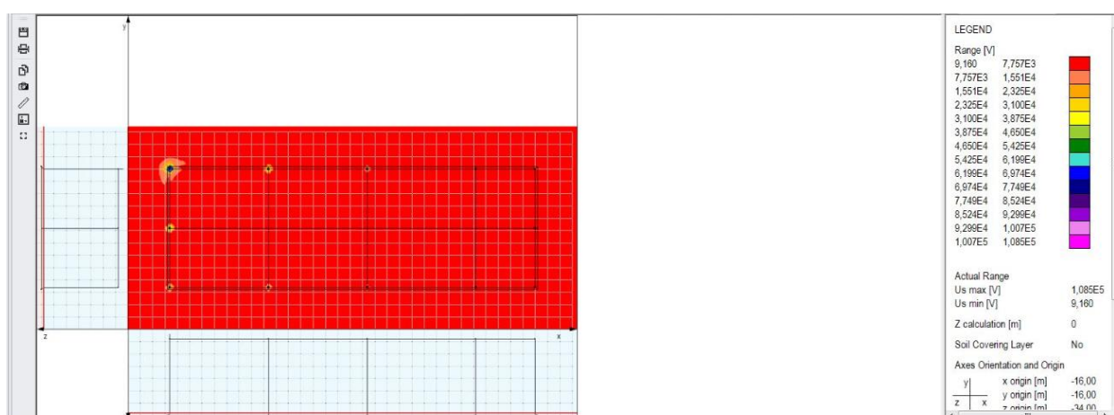
Slika 5.34: 2D prikaz napona koraka za 1. negativni impuls
