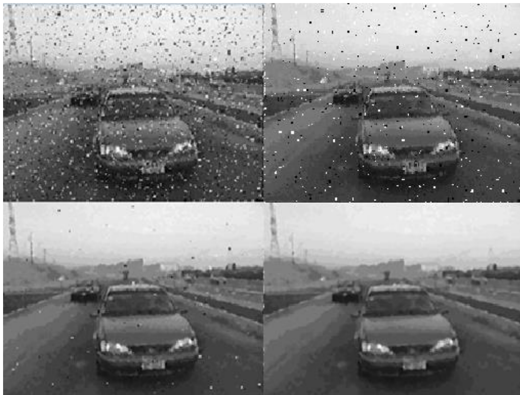
Sl. 3.12. Originalna slika i slike filtrirane medijan filtrom različitog kernela (redom 3x3, 5x5, 7x7) [12]
