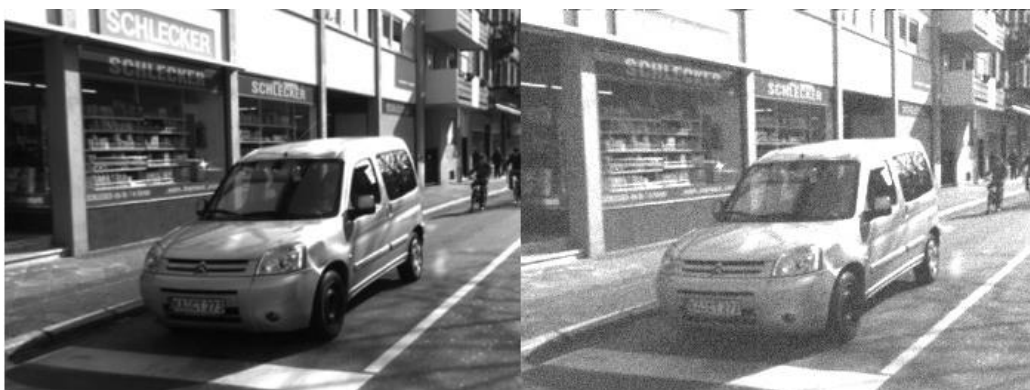
Sl. 2.1. Originalna slika (lijevo) i slika pod utjecajem Gaussovog šuma (desno) [2]
