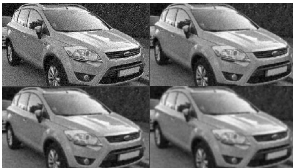
Sl. 3.17. Originalna slika i slike filtrirane Gausovim filtrom različitog kernela (redom 3x3, 5x5, 7x7) [11]
