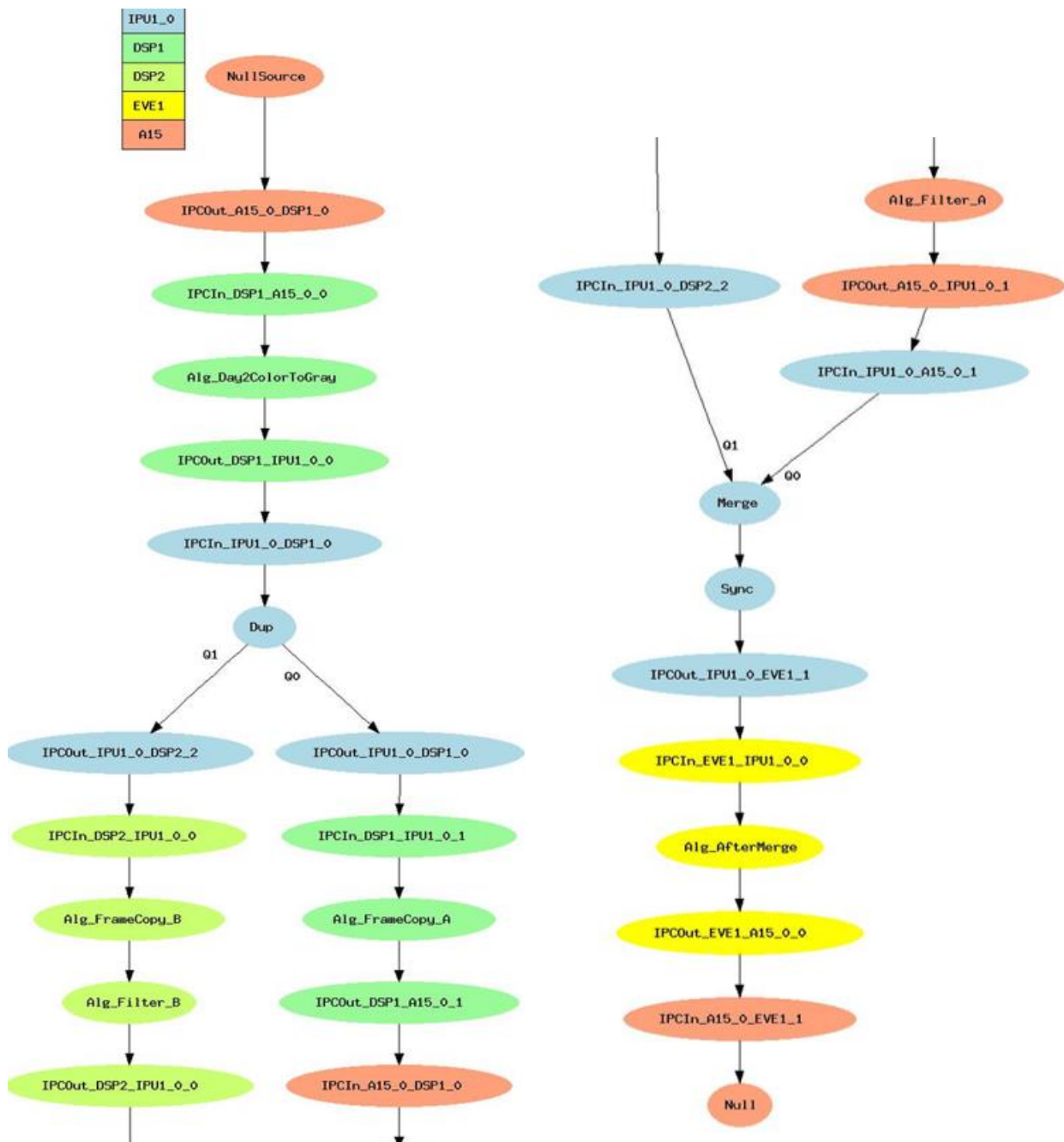
Sl. 4.10. Primjer Links and chains usecase -a kombinacije A15 i DSP CPU-a
