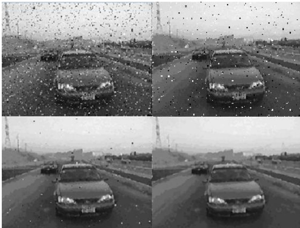
Sl. 3.12. Originalna slika i slike filtrirane medijan filtrom različitog kernela (redom 3x3, 5x5, 7x7) [12]
