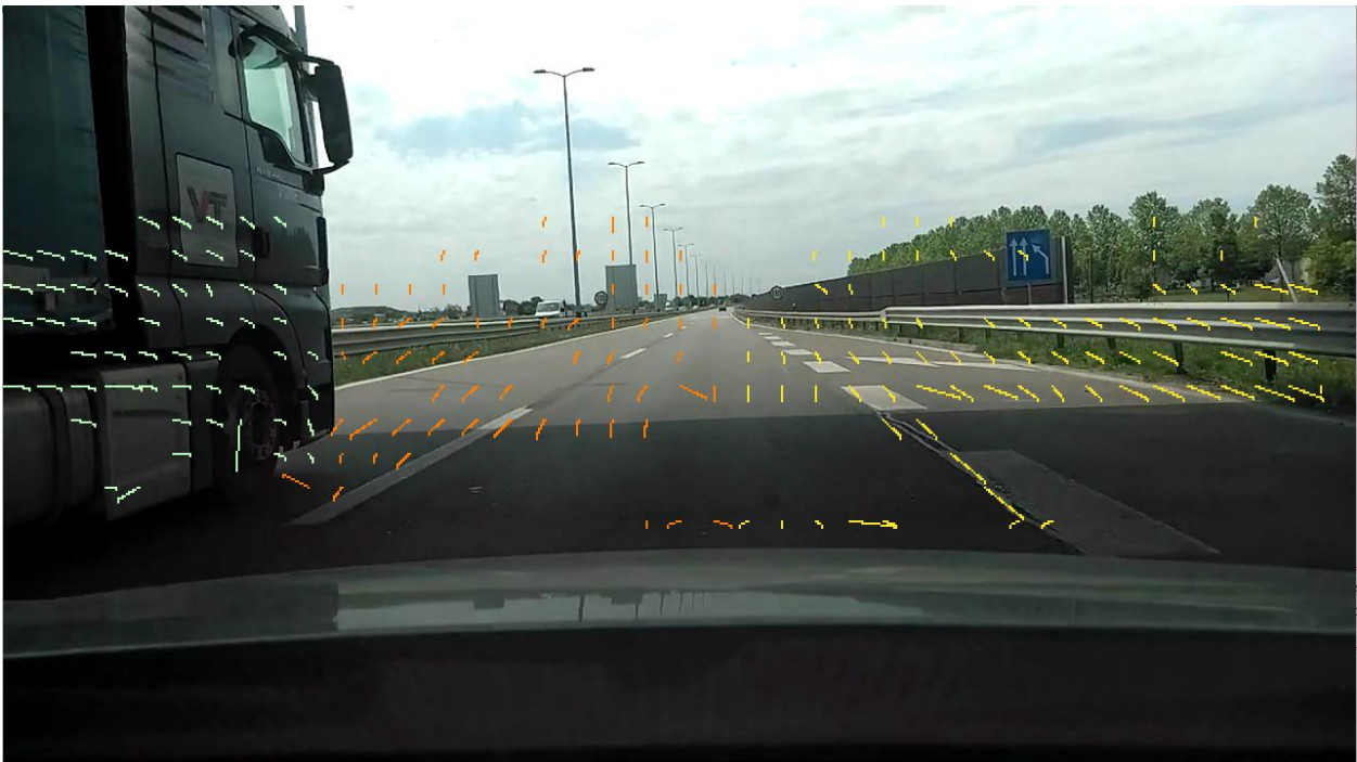
Slika 4.16. Iscrtani grupirani VP za 9. par okvira iz niza pokretna kamera, rezolucije okvira 1280x720 elemenata slike uz makroblok 32x32 elementa slike, korištenjem metode EBMA za pronalazak VP.
