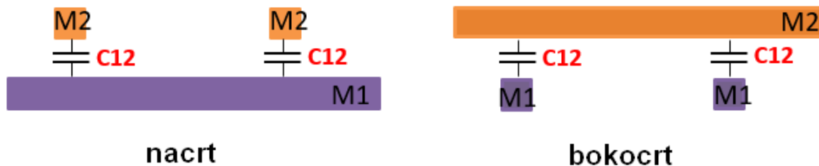
Slika 4.1. Parazitni kapaciteti među slojevima [23]
