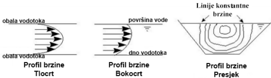
Slika 5.2. Profili brzine vode na vodotoku [5]
