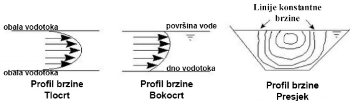
Slika 5.2. Profili brzine vode na vodotoku [5]
