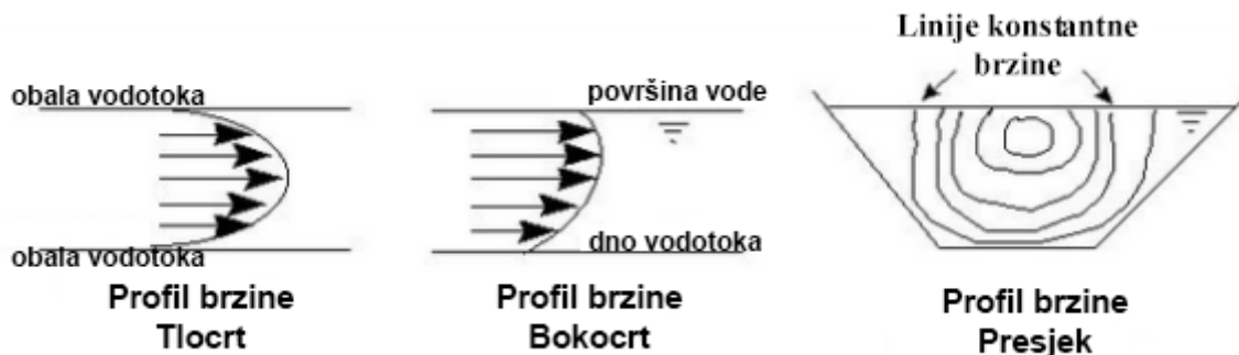
Slika 5.2. Profili brzine vode na vodotoku [5]
