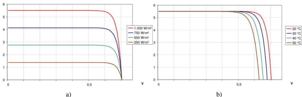
Slika 2.8. a) Strujno-naponska karakteristika fotonaponske ćelije u ovisnosti o jakosti sunčevog zračenja, b) Strujno-naponska karakteristika fotonaponske ćelije u ovisnosti o radnoj temperaturi [5]
