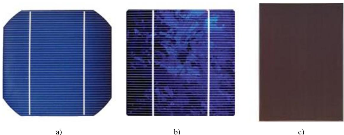
Slika 2.2. Na slici vidimo a) monokristalni fotonaponski panel, b) polikristalni fotonaponski panel, c) panel od tankog filma [2]
