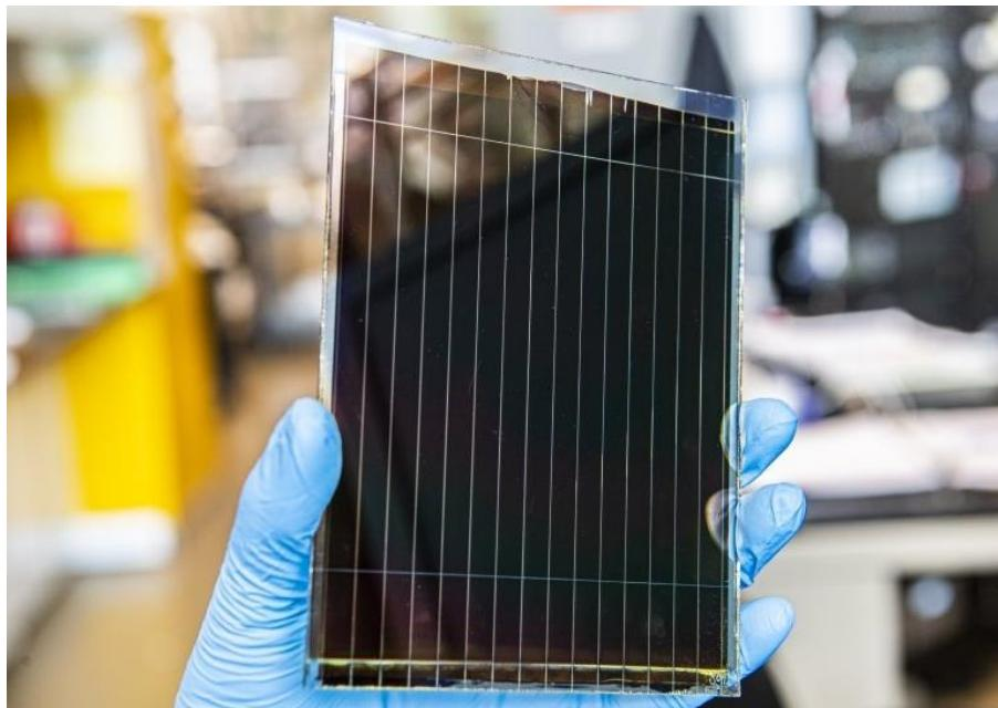
Slika 3.7. Izgled Perovskite fotonaponske čelije [10]
