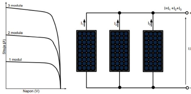
Slika 2.11. Strujno naponska karakteristika paralelno spojenih fotonaponskih modula [1]
