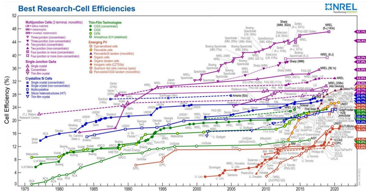
Slika 3.1. Učinkovitost fotonaponskih čelija [8]
