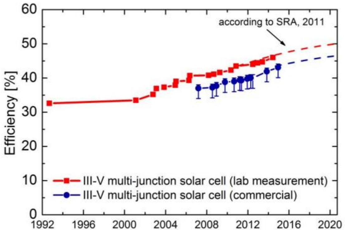
Slika 3.17. Razvoj učinkovitosti III-V fotonaponskih čelija sa više spojeva pod koncentriranim svjetlom [11]
