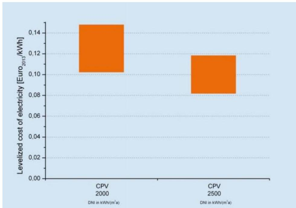
Slika 3.14. Nivelirani trošak energije za koncentrirane fotonaponske sustave kada imamo jako sunčev zračenje od 2000kWh/m<sup>2</sup> i 2000kWh/m<sup>2</sup> [11]
