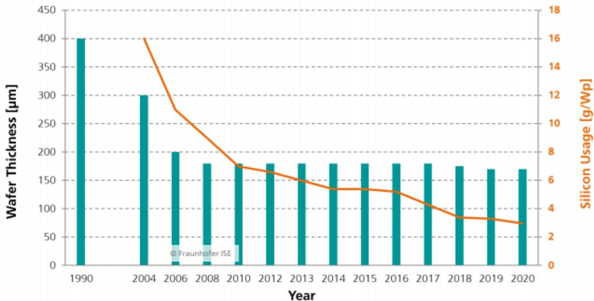
Slika 3.4. Razvoj kristalno silicijske fotonaponske ćelije [7]
