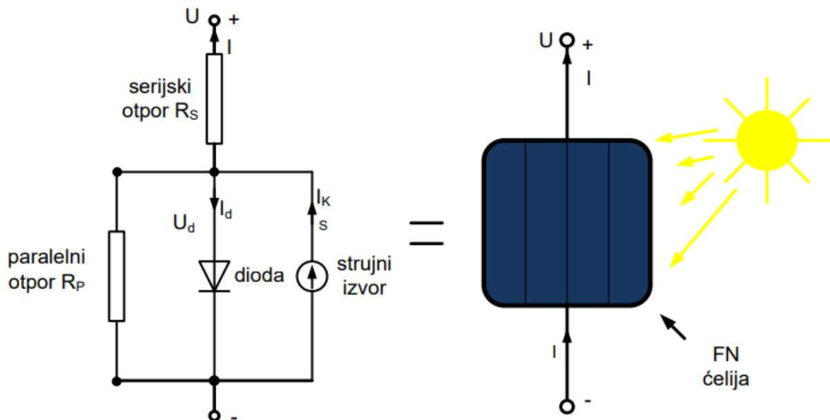
Slika 2.5. Shema fotonaponske čelije [1]
