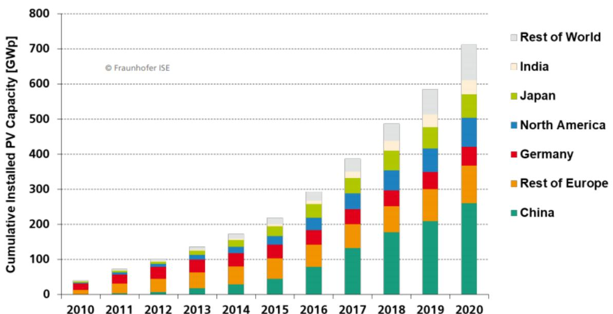
Slika 3.5. Prosječna godišnja instalirana fotonaponska energija u svijetu [7]
