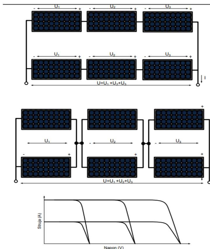
Slika 2.12. Strujno naponska karakteristika kombinirano spojenih fotonaponskih modula [1]
