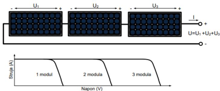
Slika 2.10. Strujno naponska karakteristika serijski spojenih fotonaponskih modula [1]
