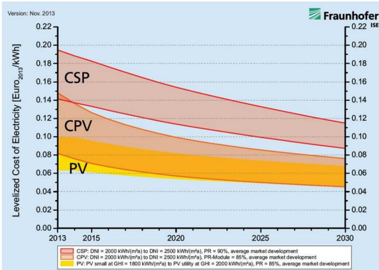
Slika 3.15. Razvoj nivelnog troška energije fotonapona , sunčeve koncentrirane snage i koncentriranih fotonaponskih postrojenja na mjestima s visokim sunčevim zračenjem
