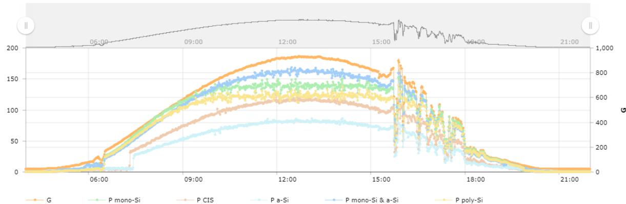
Slika 4.3. Točka maksimalne snage za navedene fotonaponske module[14]
