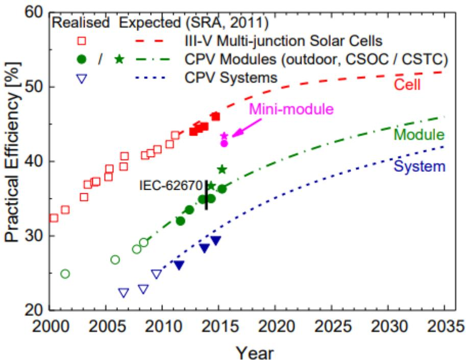
Slika 3.16. Razvoj rekordne učinkovitosti višenamjenskih fotonaponskih čelija III-V i CPV modula [11]
