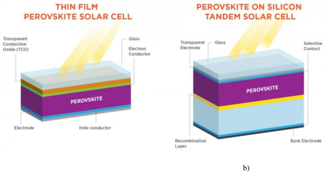
Slika 3.8. a) Perovskitna fotonaponska čelija napravljena u tehnologije tankog filma, b) Perovskitna fotonaponska čelija u tandemu sa silicijem [10]
