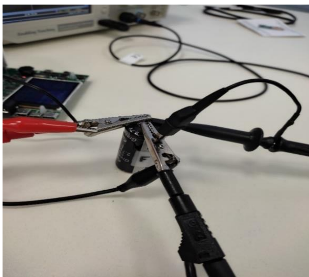
Slika 8.5. Superkondenzator „Samwha GreenCap“ 100 F, 2.7 V
