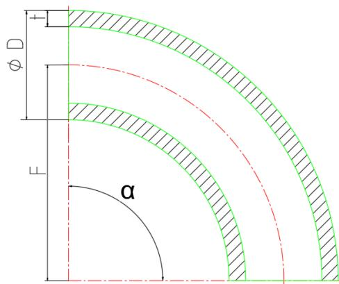
Sl. 3.5. Poprečni presjek hamburškog luka
