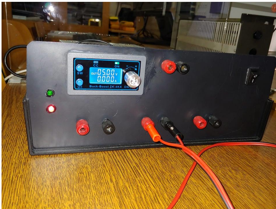
Slika 3.4. Prikaz napajanja s izlaznim naponom od 5V.
