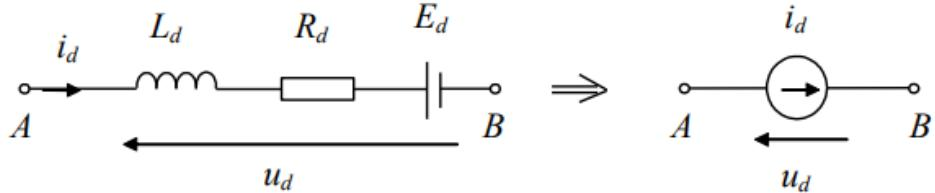
Slika 4.3. Stvarni smjerovi napona i struja istosmjernog motora u motorskom režimu rada [1].
