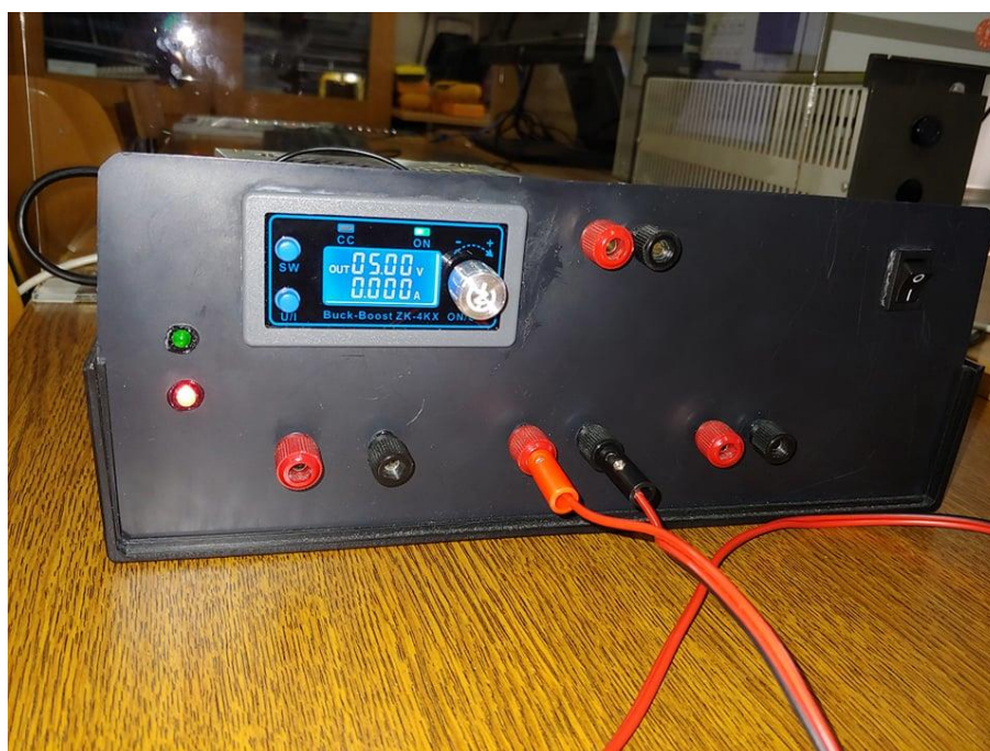
Slika 3.4. Prikaz napajanja s izlaznim naponom od 5V.
