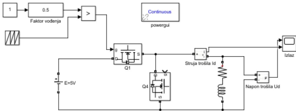
Slika 5.2. Blokovski prikaz silaznog pretvarača u Simulinku.
