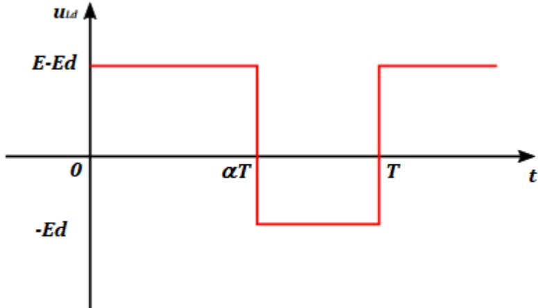
Slika 4.9. Valni oblik napona induktiviteta  $u_{Ld}$ .
