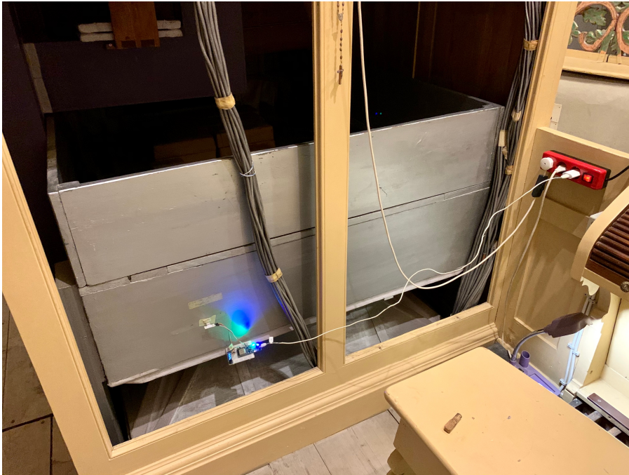
Slika 4.1. Mjerni postav za mjerenje temperature zraka servisnog izlaza mijeha
