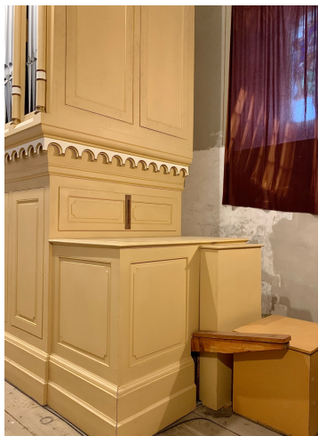
Slika P.1.2. Pogled na orgulje s desnim korpusom, produžetkom mijeha, polugom za nožno pumpanje i kutijom sustava dovoda zraka
