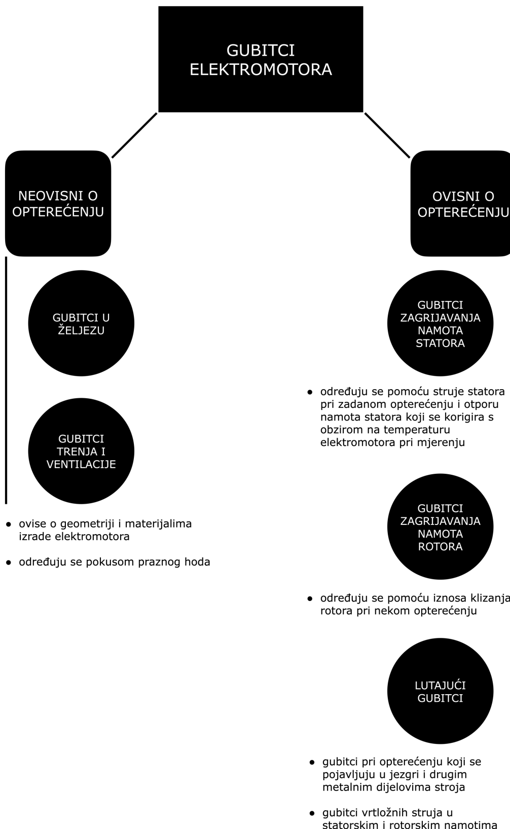
Slika 3.7. Sažet prikaz gubitaka elektromotora s pripadajućim objašnjenjima
