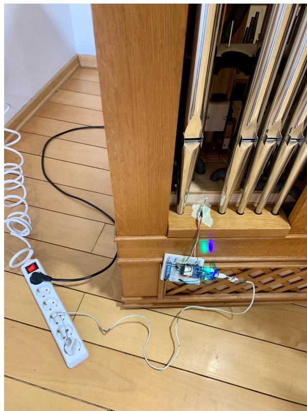
Slika 4.3. Mjerni postav za mjerjenje temperature zraka u zračnici
