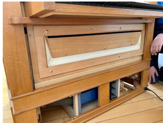
Slika P.2.4. Pogled na zračnicu s pomičnom membranom u ulozi mijeha i komore sustava dovoda zraka s izlaznom komorom i zvučnom izolacijom
