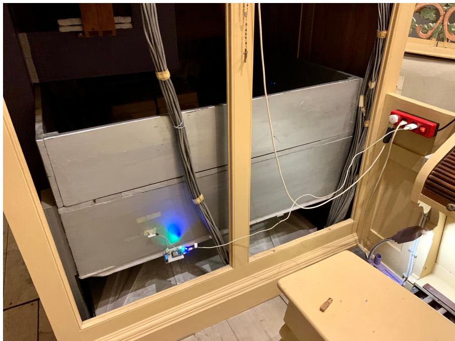
Slika 4.1. Mjerni postav za mjerjenje temperature zraka servisnog izlaza mijeha
