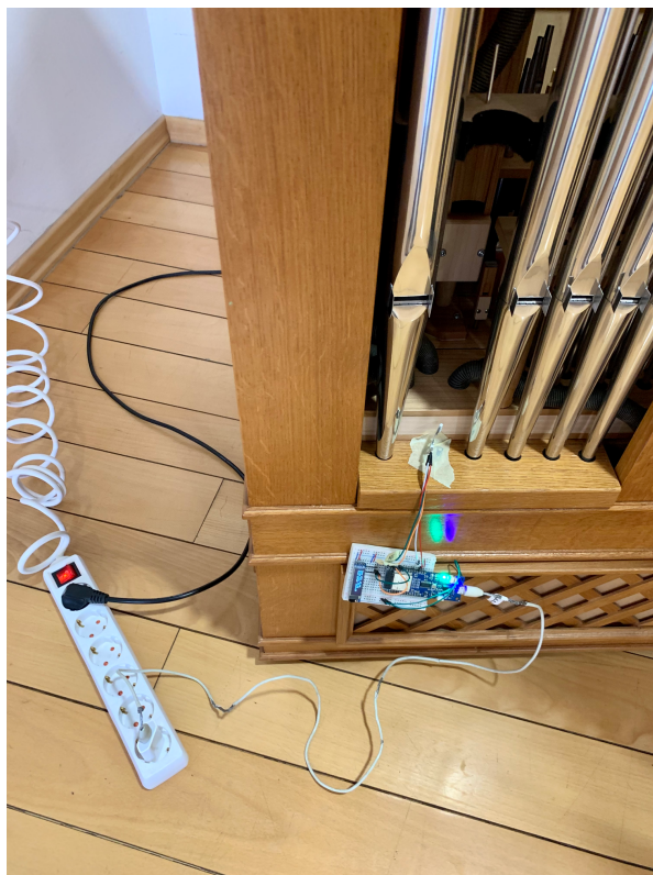
Slika 4.3. Mjerni postav za mjerenje temperature zraka u zračnici
