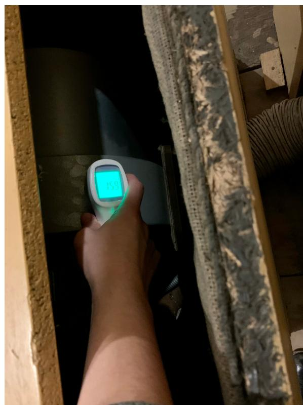
Slika 4.2. Mjerni postav za mjerjenje temperature kućišta sustava dovoda zraka
