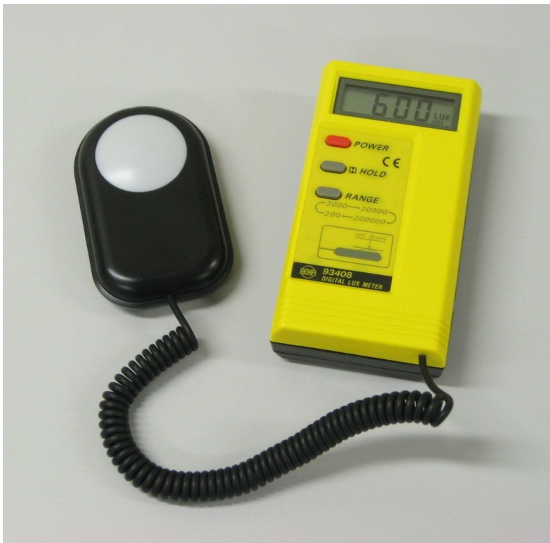
Slika 4.1: Luksmetar kojim je mjerena rasvjetljenost
